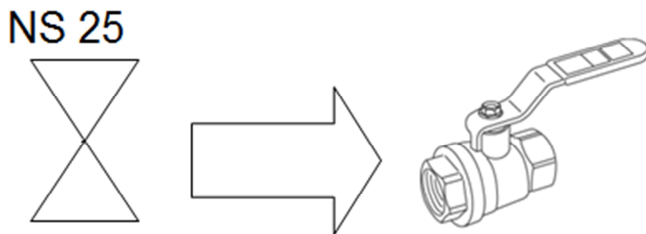
Kuva 26. Sulkumerkintä 2D-piirustuksissa ja tietomallissa [26].
