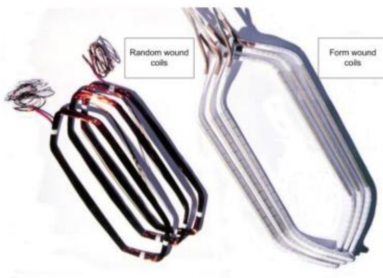
Kuva 28. Vilskekäämitys ja muotovytyhtikäämitys.
