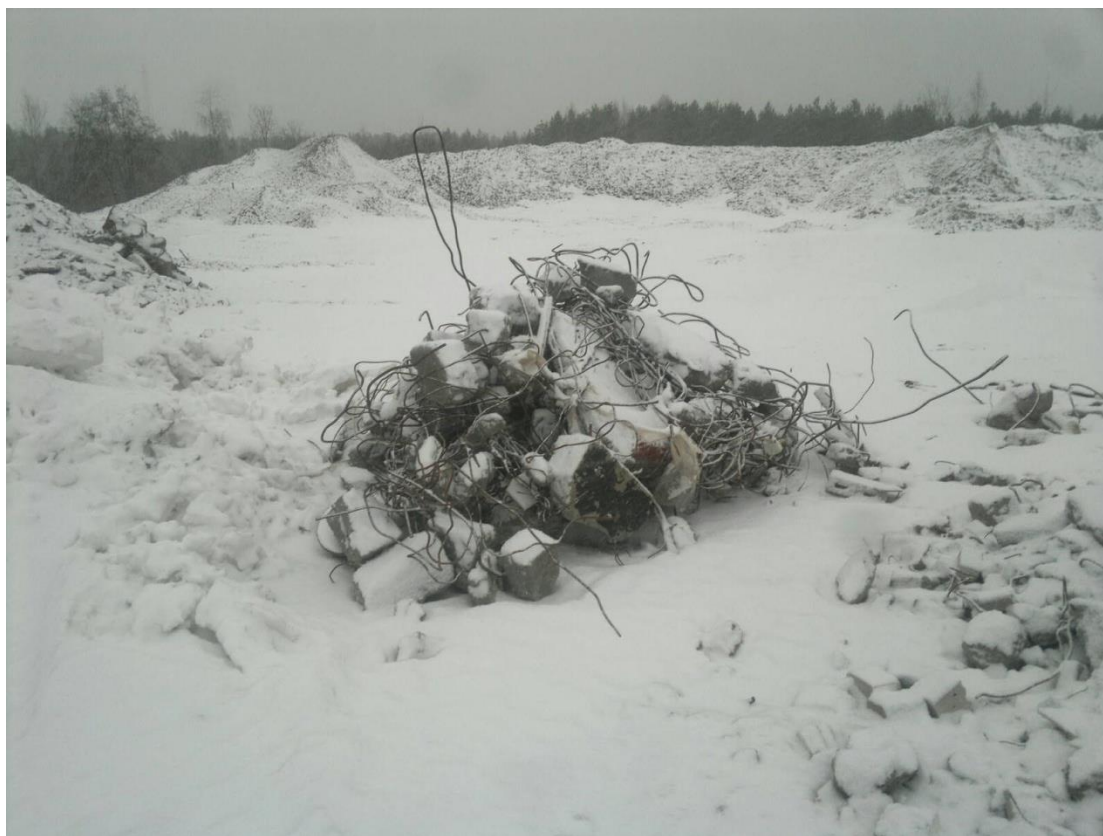
KUVA 1. Betonista erotettuja teräksiä. Kuva: Lauri Kervola 2013.
