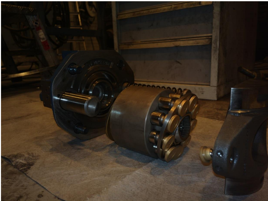
Kuva 9. Hydrauliikkapumppu korjauksessa kuumavalssaamon korjaamolla. (Outokumpu Tornio Works k-asema, hakupäivä 11.4.2014.)
