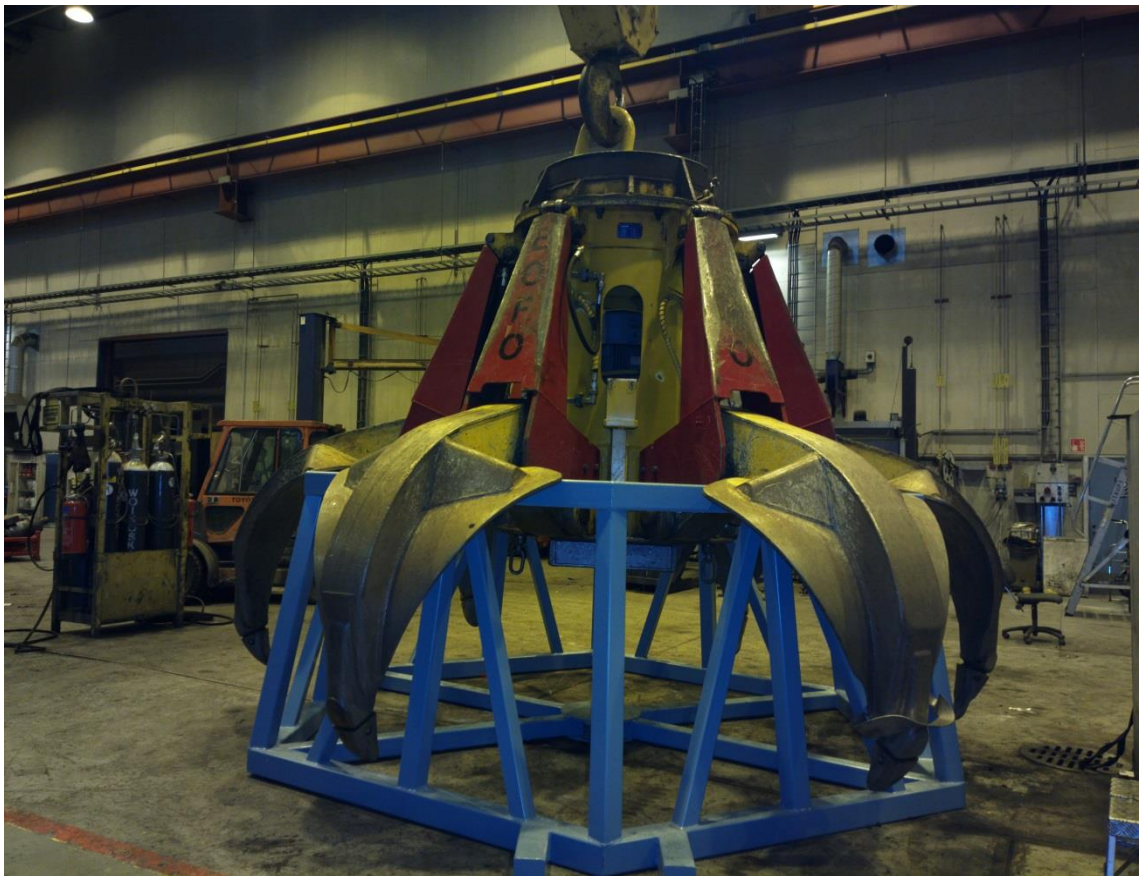
Kuva 10. Punainen kahmari huollossa kuumavalssaamon korjaamolla. (Outokumpu Tornio Works k-asema, hakupäivä 12.3.2014.)
