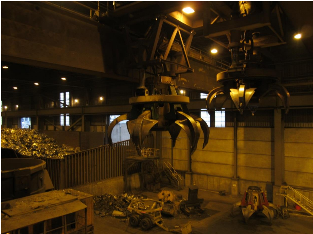
Kuva 8. Romupihan itäpään iso ja pieni kahmari. Isompi 5,0m 3 kahmari, joihin keskitytään tässä opinnäytetyössä.
