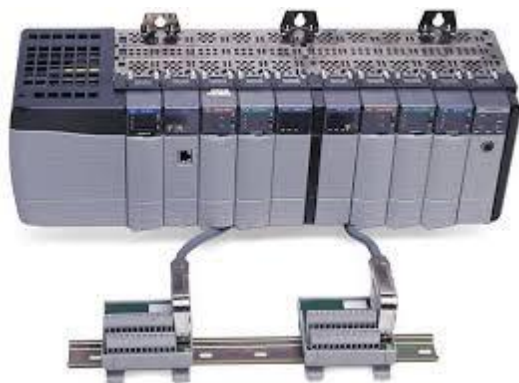
KUVA 20. Control Logix-logiikka ja johdotussovittimet (VEO)
