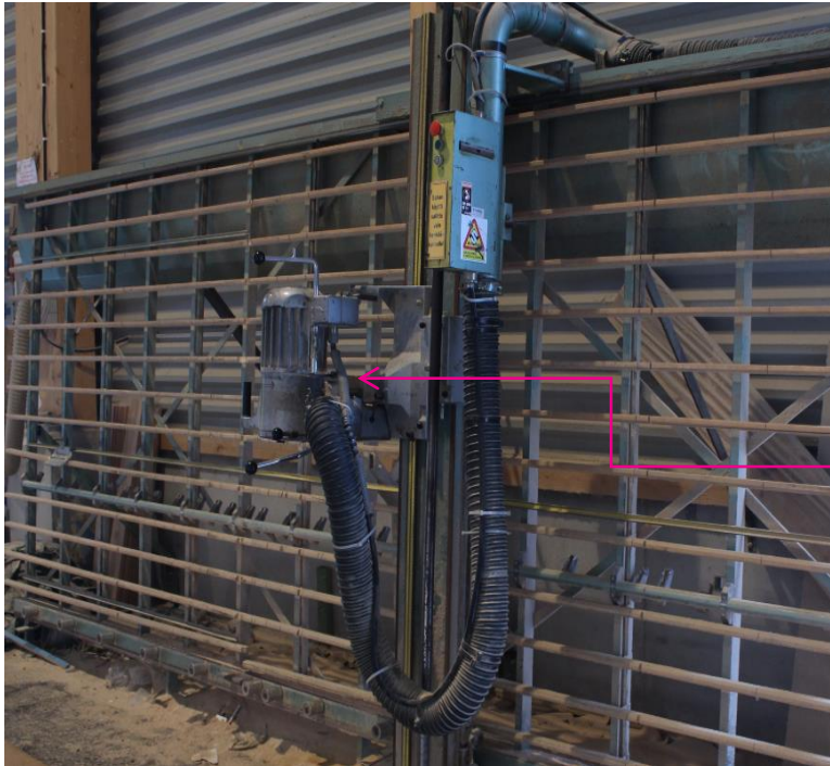
Kuva 13. Levyleikkuri, missä juoksuvaunu käännetty 90 astetta. Kuva Nico Lapveteläinen 2014.
