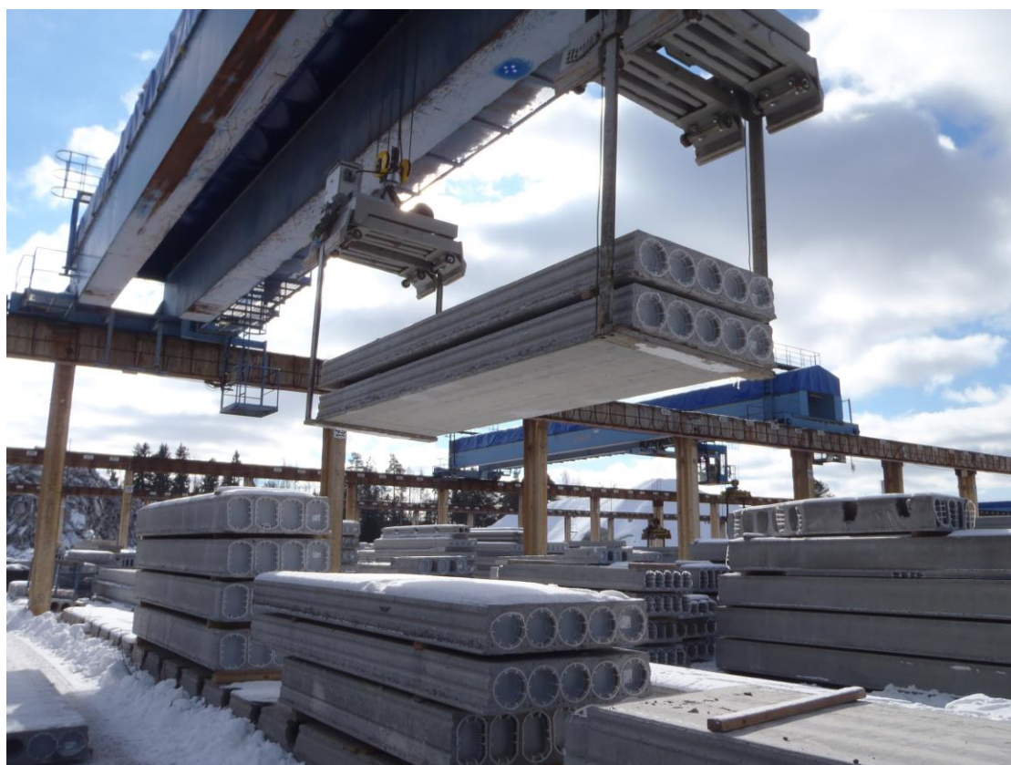
KUVIO 6. Nippunosto, jossa nostetaan kaksi elementtiä yhdellä kerralla.
