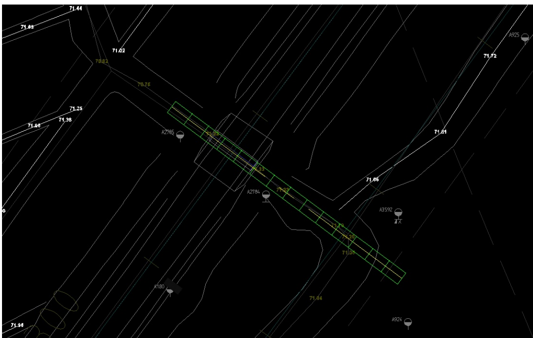
KUVA 22. Edellisen kuvan ympäristöön lisätty hahmoteltu betonirumpurakenne
