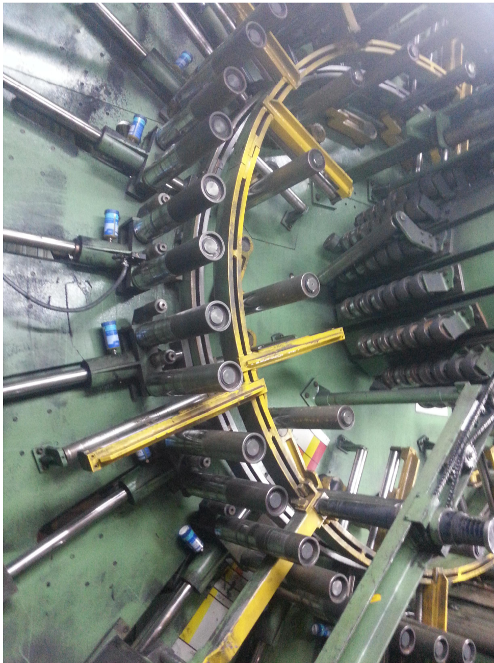
Kuva 28. H4 nauhavaraajan liukupinnat System 24 -patruunoilla
