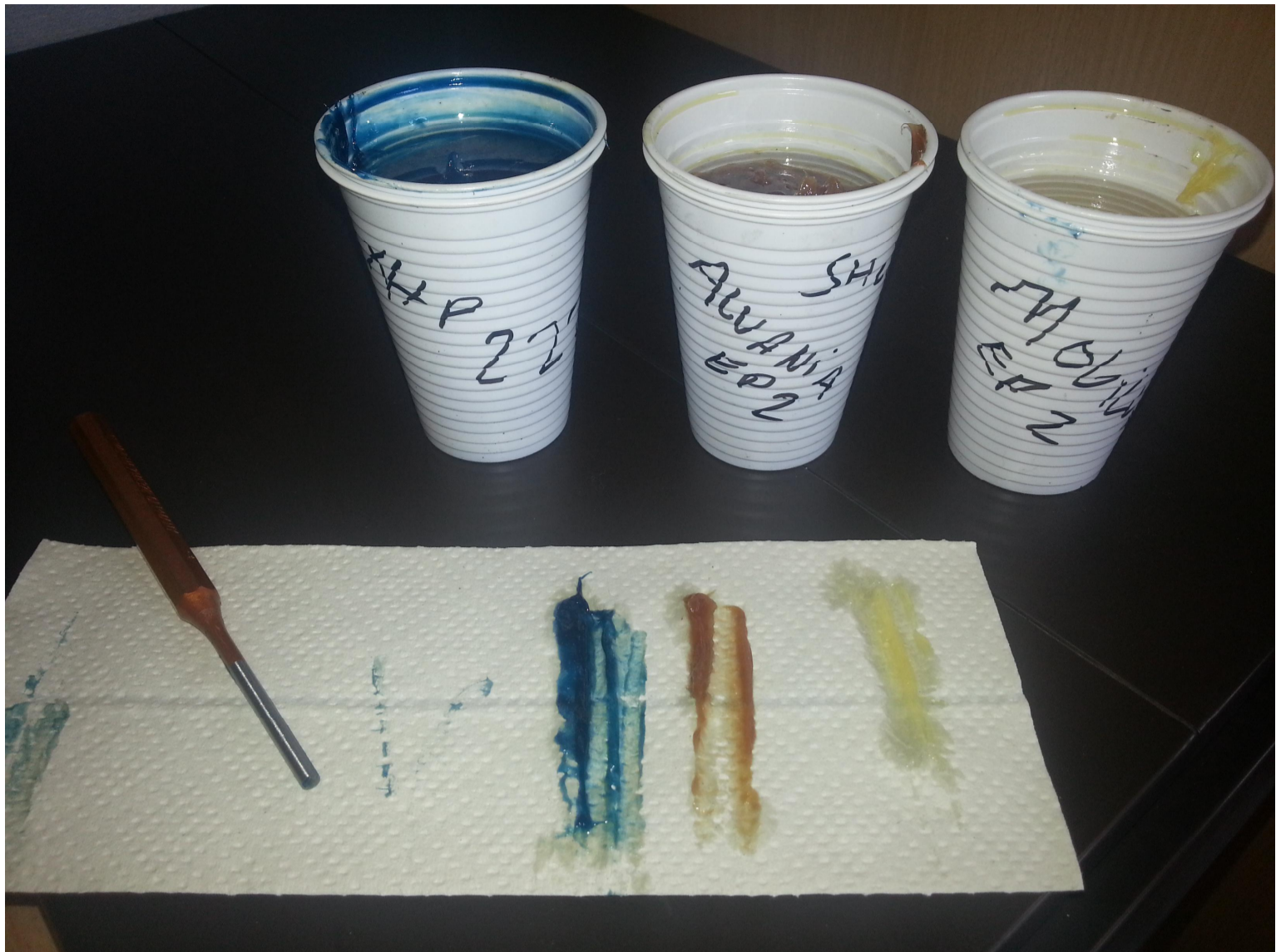
Kuva 8. Rasvan tartuntaominaisuuksien testaus
