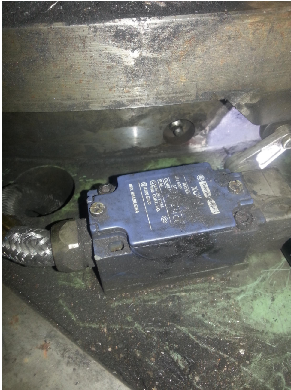
Kuva 29. H4 Aukikelaimen kääntölaakerin rasvausnipa ja tiellä oleva mekaaninen raja
