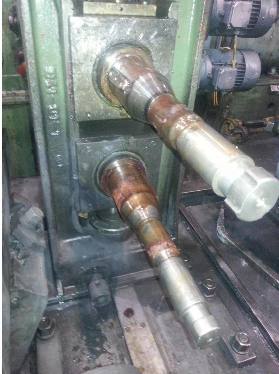
Kuva 14. Vaaka akseleiden ruosteen määrä yhden työvuoron jälkeen
