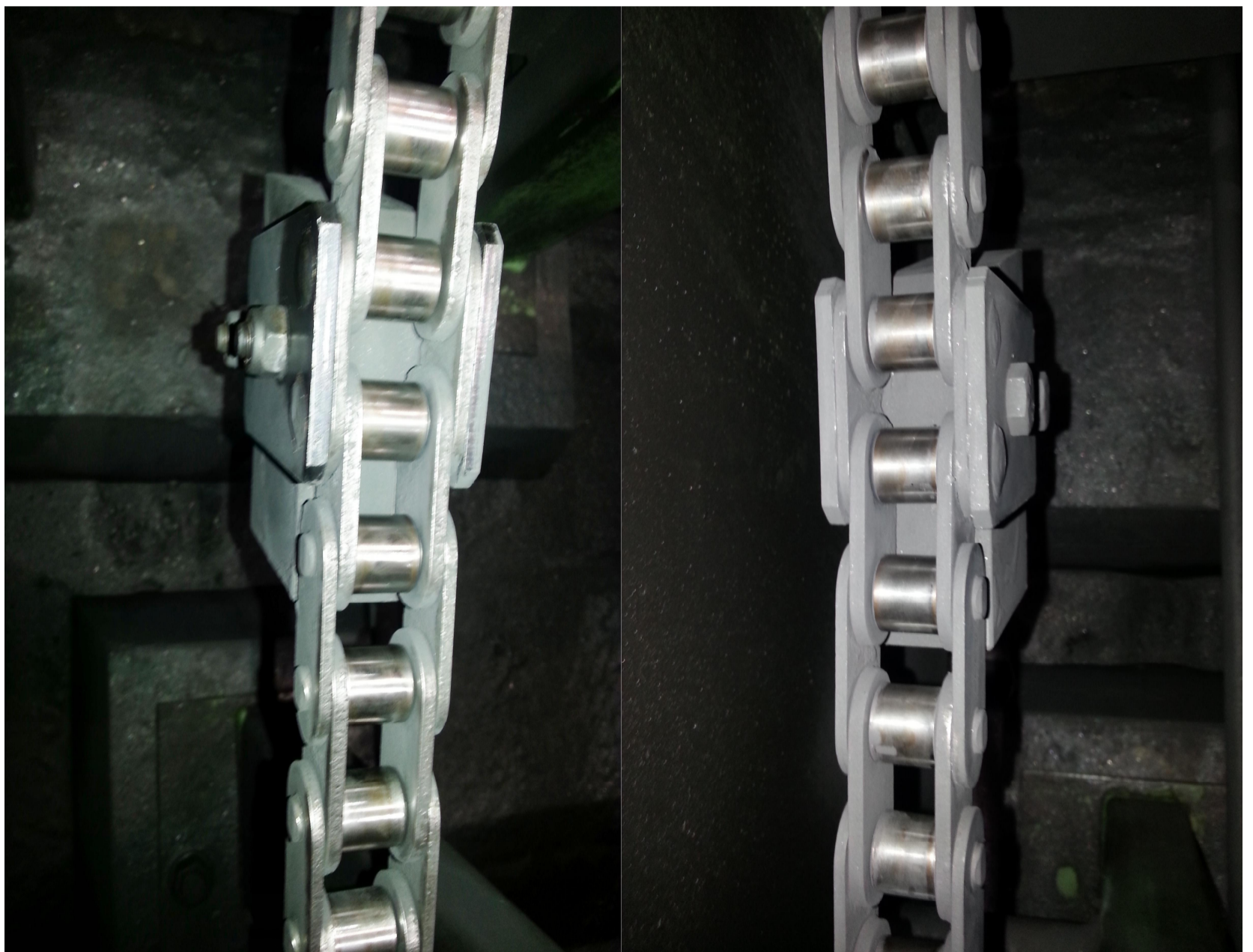
Kuva 27. H4 niputuksen sivusiirron ketju kuukauden voitelulla ja ilman voitelua
