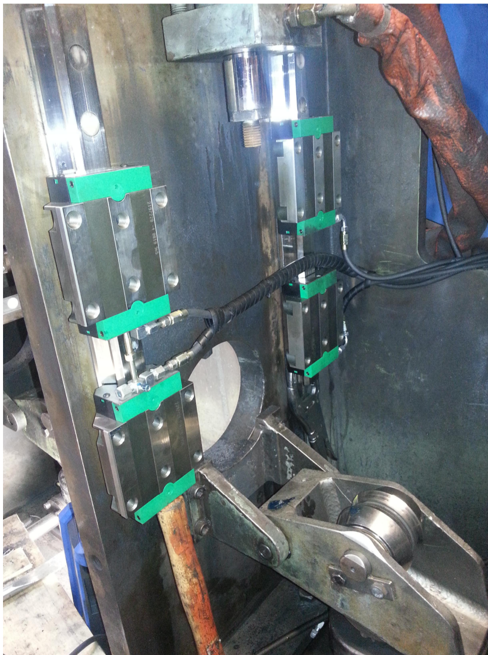
Kuva 33. Pituussaumahöylien pystyjohdekelkkoihin asennetut korkeapaineletkut
