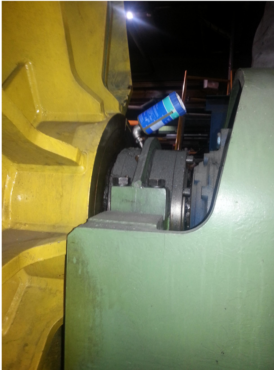
Kuva 26. H2-linjan nauhavaraajan pyöritysakseli varustettuna System 24 -patruunalla
