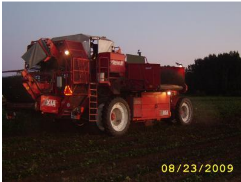
KUVA 10 Pyhäjärven Perunankorjuu Oy:n itse kulkeva kahta riviä nostava perunannostokone. Merkki Dewulf ja vuosimalli 2005.
