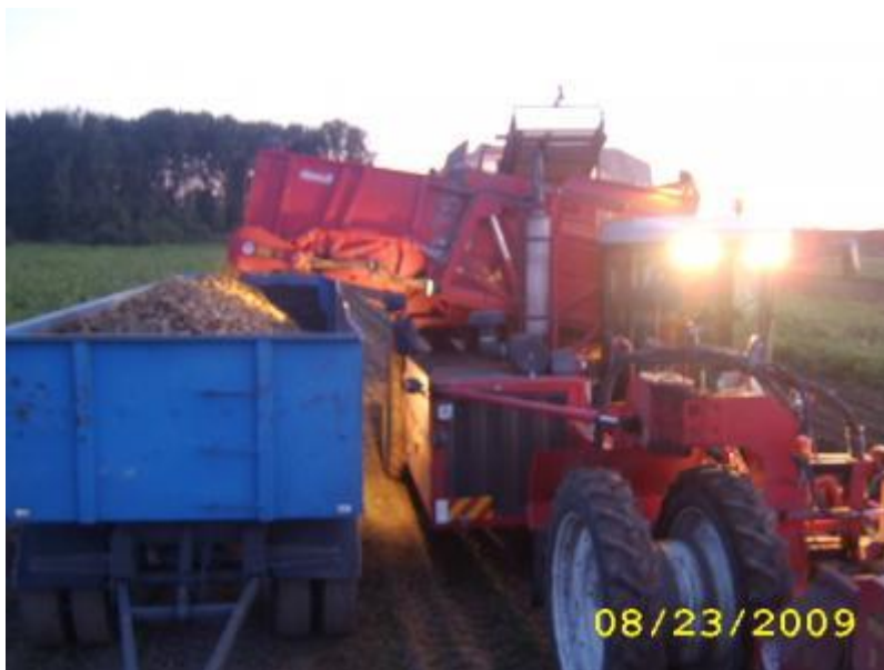
KUVA 12 Dewulf nostokone tyhjentämässä elevaattori säilötä, jonka maksimitilavuus 6t/perunaa.
