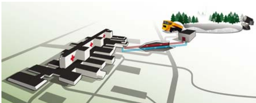
KUVA 12. Yleiskuva Sundsvallin sairaalan lumen jäähdytyksestä, (lvn.se)
