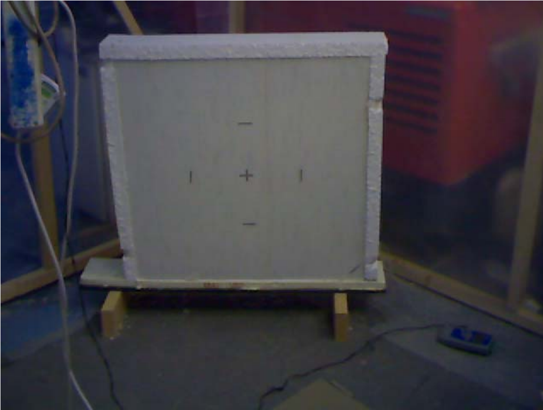
KUVA 30. Vesikiertoinen Kahi-runkopontti, digikuva tutkitusta rakenteesta
