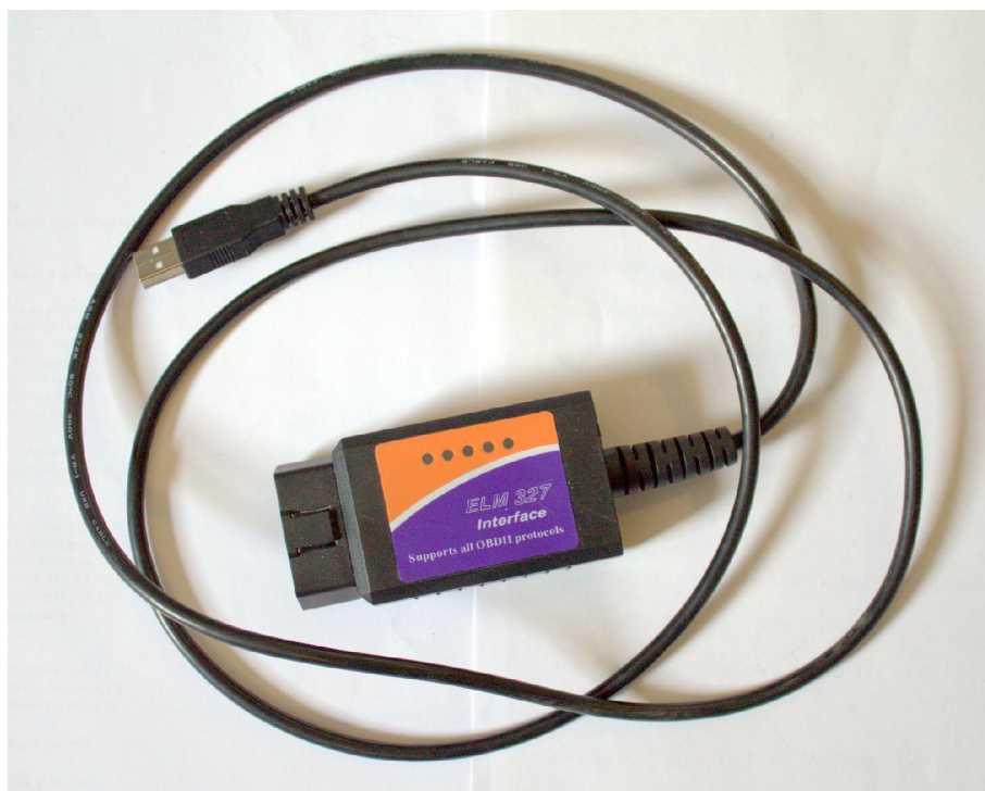
Kuva 1. USB-liitännällä varustettu ELM327 OBD-lukija
