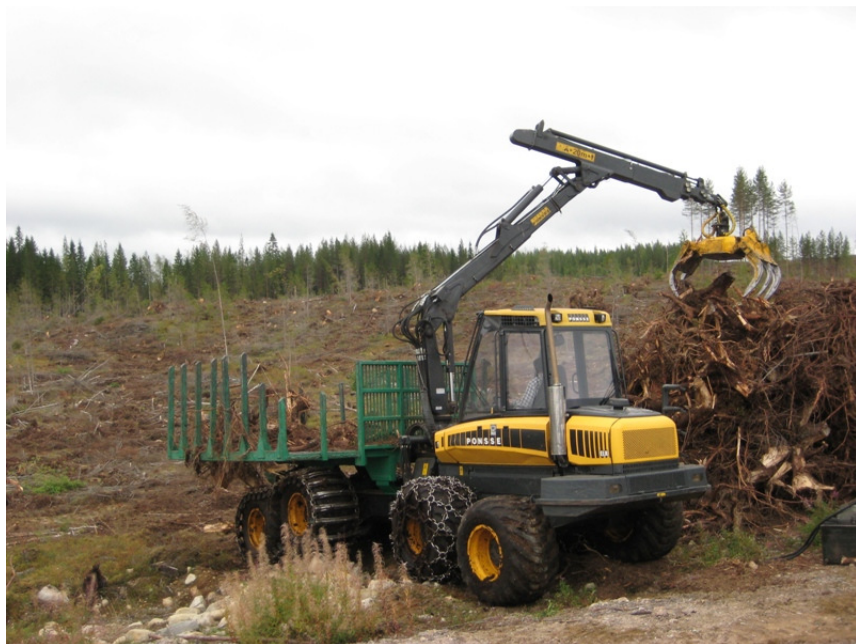
KUVA 11. Kuormatraktori purkaa kuormaa tienvarsivarastoon.
