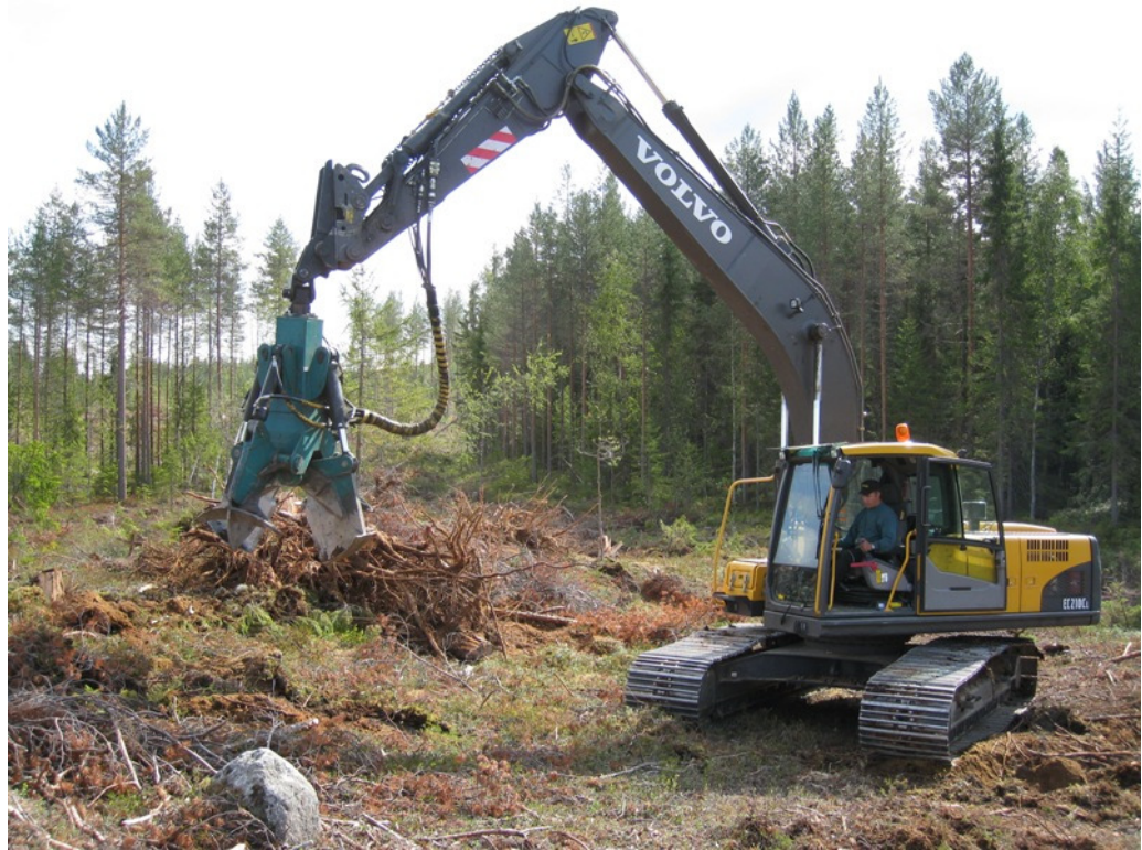
KUVA 2. Testimittauksissa mukana ollut Monosen kannonnostolaite ja alustakoneena toiminut 24 tonnin telakaivinkone (Kumpare 2009).
