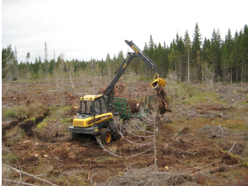
KUVA 10. Kuormatraktori tekee kantokuormaa.
