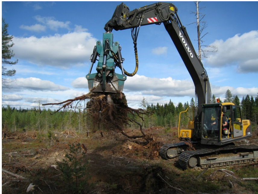
KUVA 7. Kanto on nostettu ja sitä puhdistetaan (Kumpare 2009).
