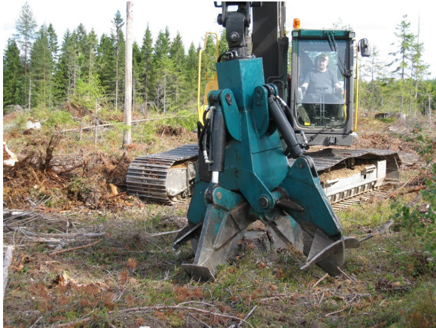
KUVA 6. Kannonnostolaitetta asetetaan nostettavan kannon ympärille (Kumpare 2009).
