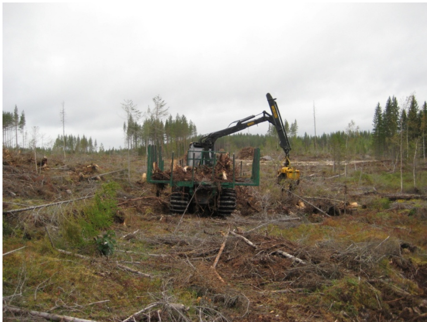
KUVA 9. Levennetyllä kuormatilalla varustettu kuormatraktori.
