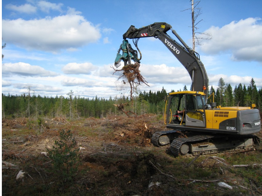
KUVA 8. Kanto on pudistettu ja se siirretään kasaan odottamaan lähikuljetusta (Kumpare 2009).
