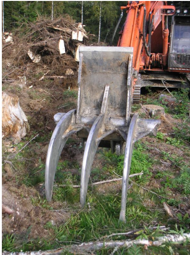
KUVA 1. Telakaivinkoneeseen kiinnitetty muokkauslevyllä varustettu kantohara (Leinonen 2009).
