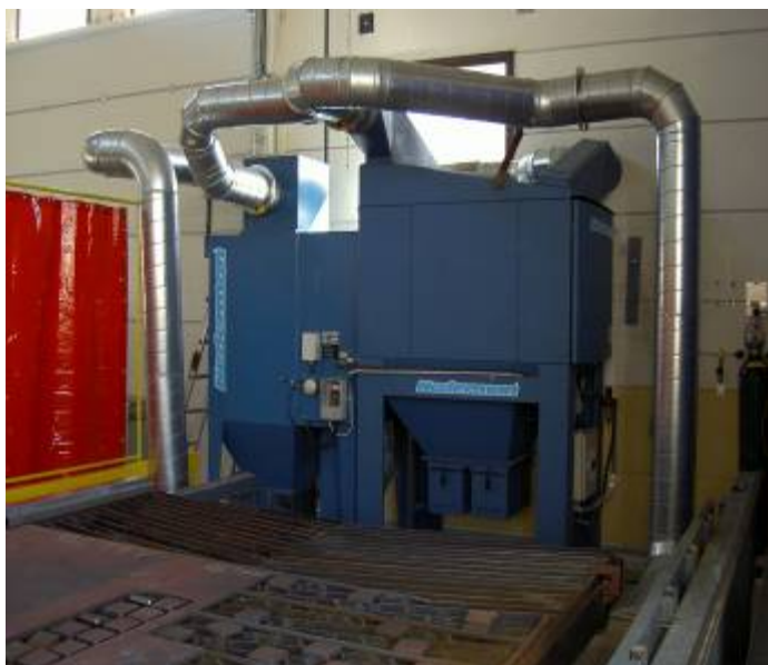
KUVA 18. Suodatin laitteisto imupöydän päässä
