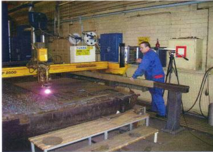
Kuva 2. Mittausjärjestelyt mittauspisteessä 1. Mikrofoni sijoitettu työntekijän välittömään läheisyyteen.
