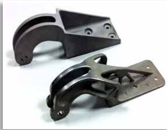
KUVA 10. Suihkumoottorin kuoren saranat. Ylhäällä perinteisesti valmistettu sarana ja alhaalla pikavalmistettu sarana.
