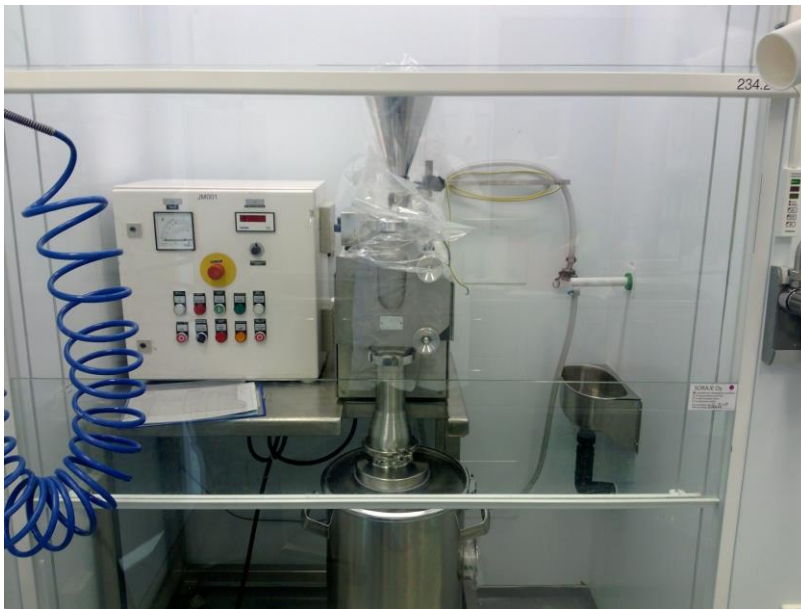
Kuva 15. Alpine 100 upz nastamylly tuoteastia kiinnitettynä
