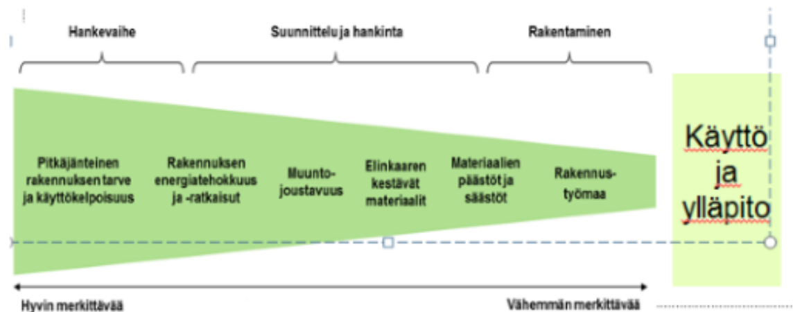
Kuva 2. Rakentamisen eri vaiheiden merkitys elinkaaren aikaisiin ympäristövaikutuksiin (Rakennusteollisuus ry 2021d).
