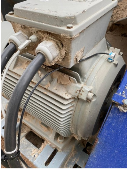
Kuva 10. Mittauspää kiinnitettyä sähkömoottoriin. (Rossi, 2021)
