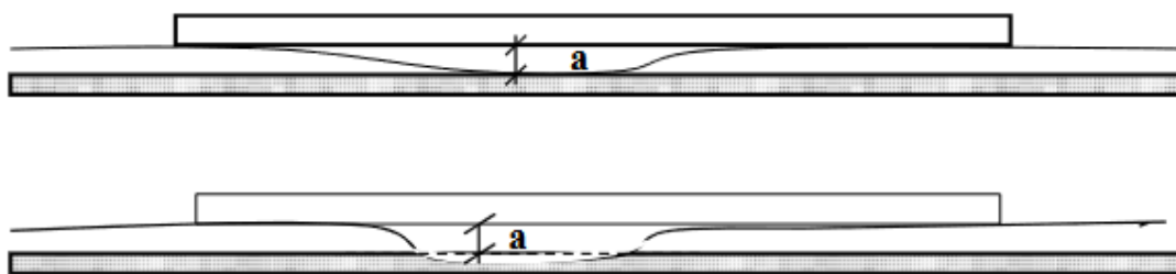
Kuva 3. Polanteen tasaisuuden mittaaminen tien poikkisuunnassa (Maanteiden talvihoito. Laatuvaatimukset 2018)
