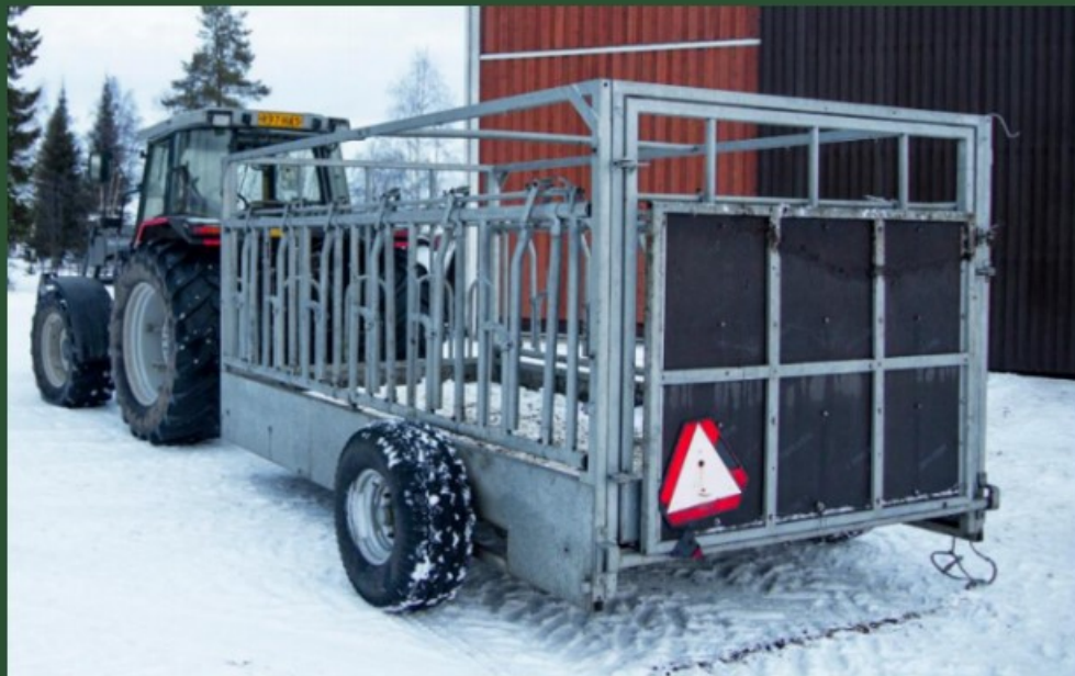
Traktorilla siirrettävä lastauskärry kaikenikäisille eläimille.
