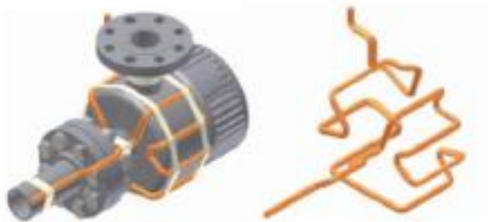
KUVA 29. Pumpun kaapelointi (mukaiillen Thermon 2022)
