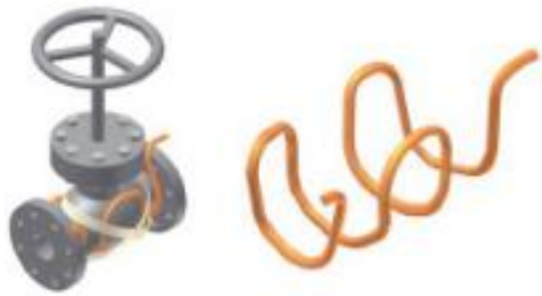
KUVA 28. Venttiilin kaapelointi ”perhosmallilla” (mukaiillen Thermon 2022)
