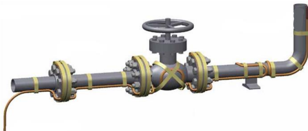
KUVA 30. Kaapelit kiinnitettynä putken osiin (mukaillen Thermon 2022)
