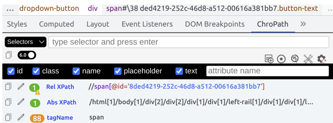
Kuva 13. ChroPath-lisäosa näyttää elementin CSS-selektorin.
