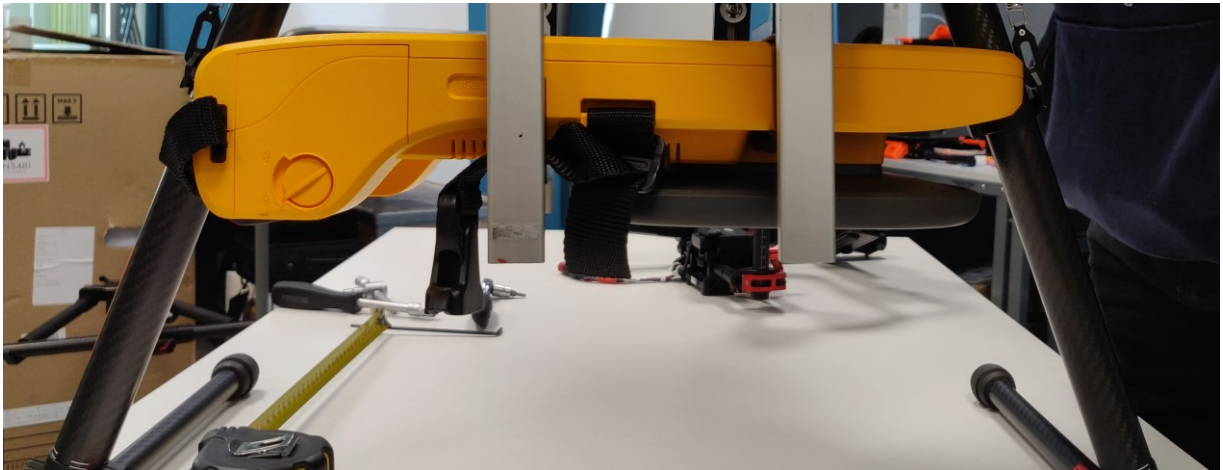
KUVA 9. Ultraäänikamera kiinnitettynä prototyyppiin
