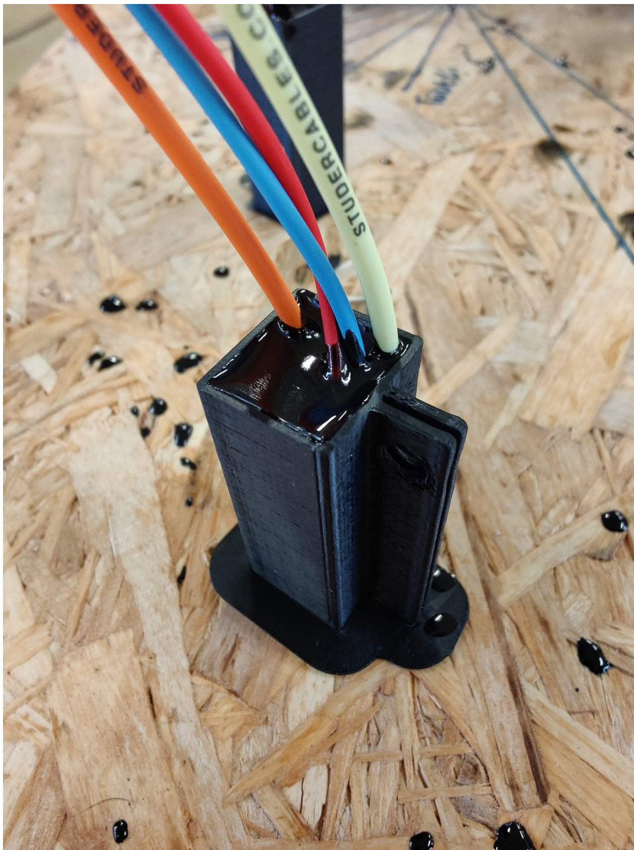
Kuva 7. Valmis esilatauspiiri kotelossaan valettuna.
