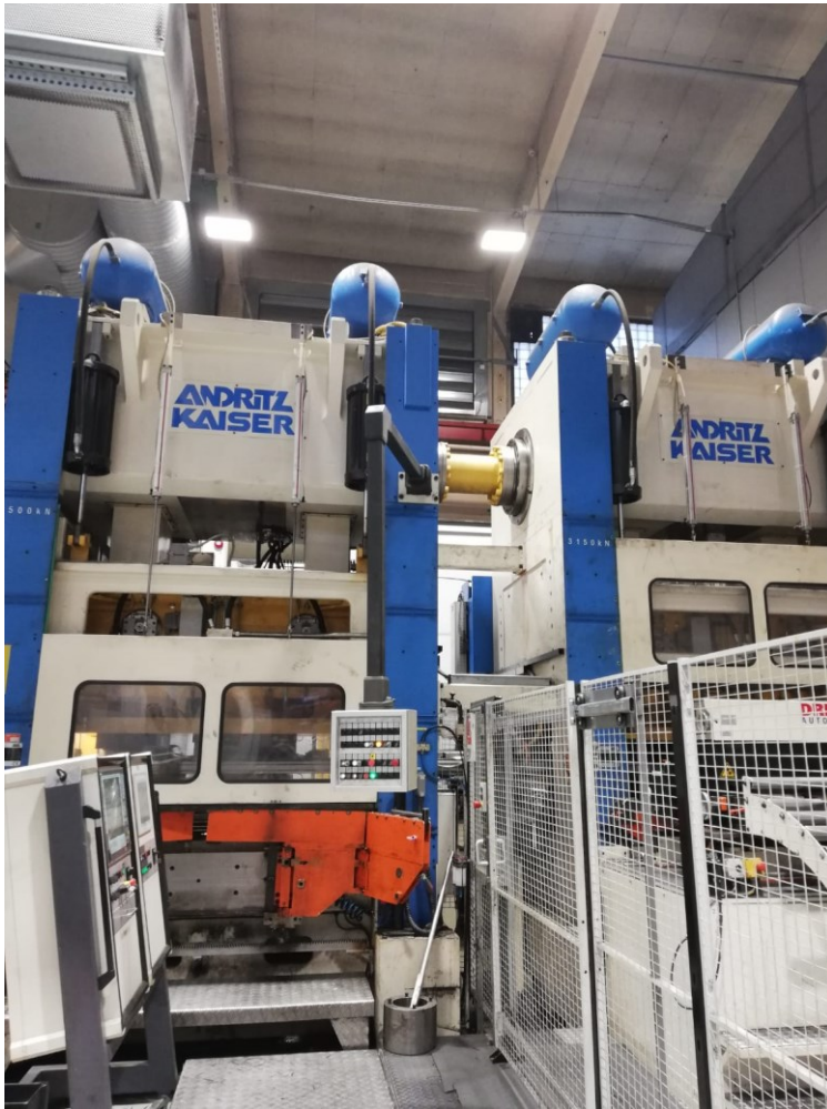
Kuva 19. Kaiser 3, suurempi yhteisurituskone urittamossa.
