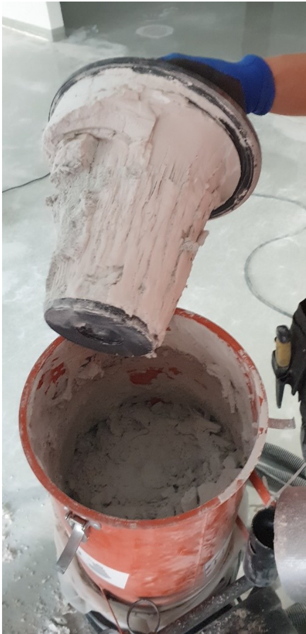
Kuva 5. Imurin suodatin tukossa.
