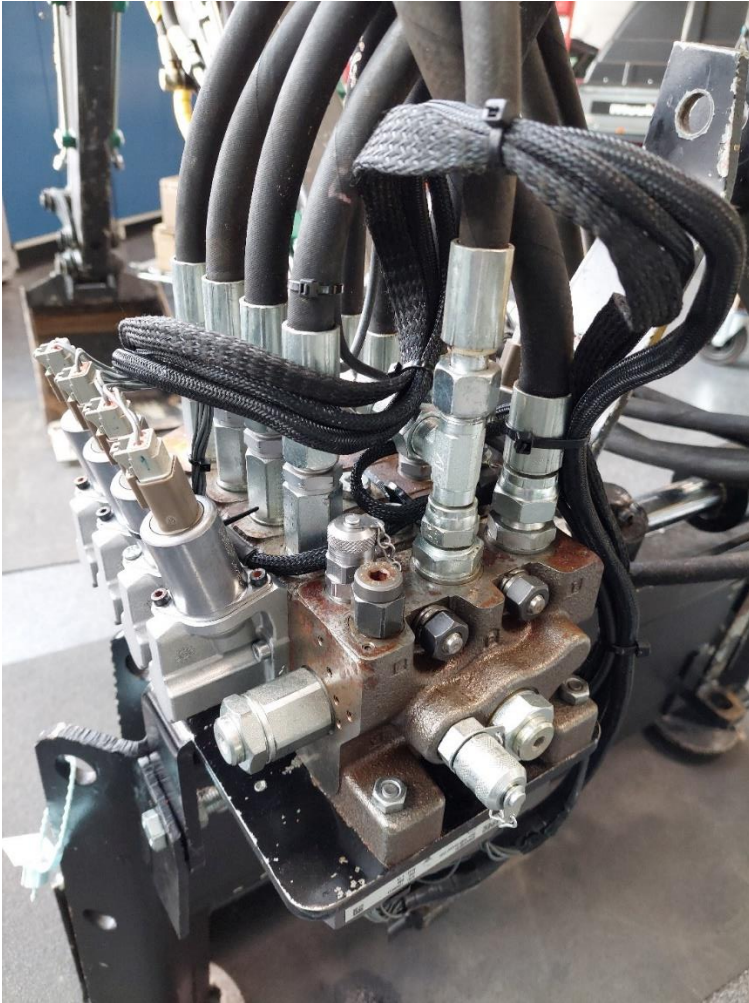
Kuva 4. Sähköisesti ohjattu suuntaventtiiliryhmä.
