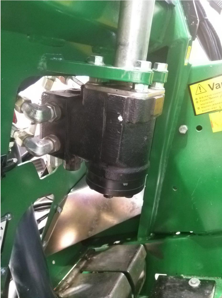
Kuva 3. Avant -pienkuormaajan hydrostaattinen ohjausventtiili.
