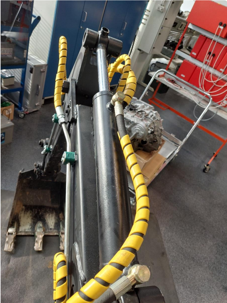
Kuva 5. Kaivinkoneen taittopuomin kaksitoiminen sylinteri.
