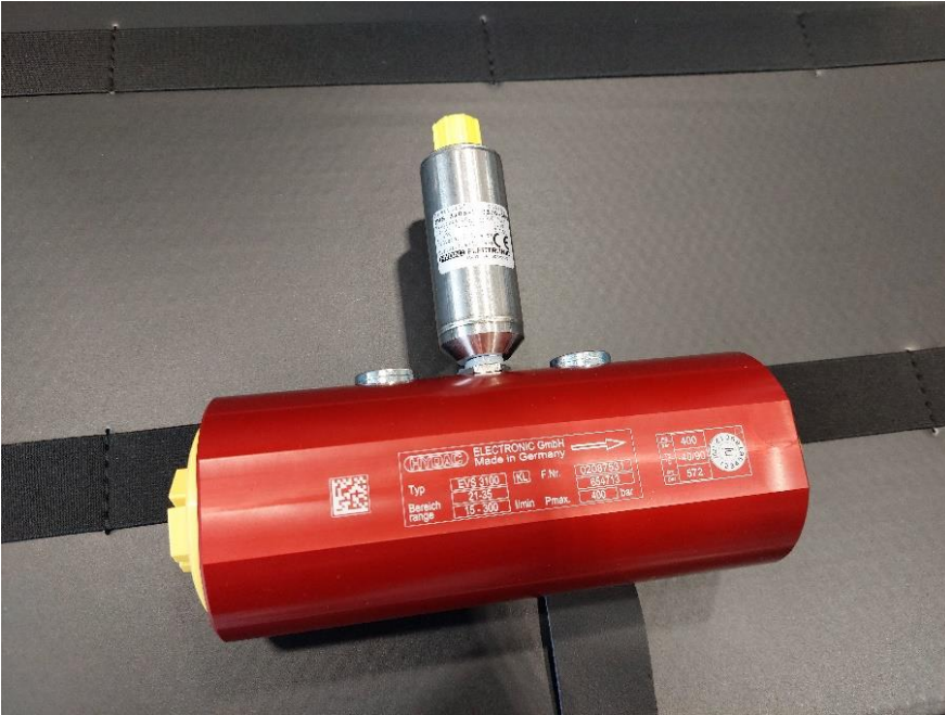
Kuva 8. Hydac -testilaitteen virtausmittausturbiini.
