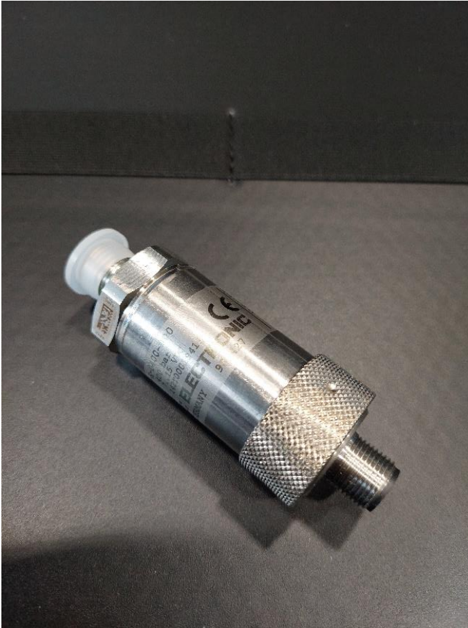
Kuva 7. Hydac -testilaitteen painelähetin.
