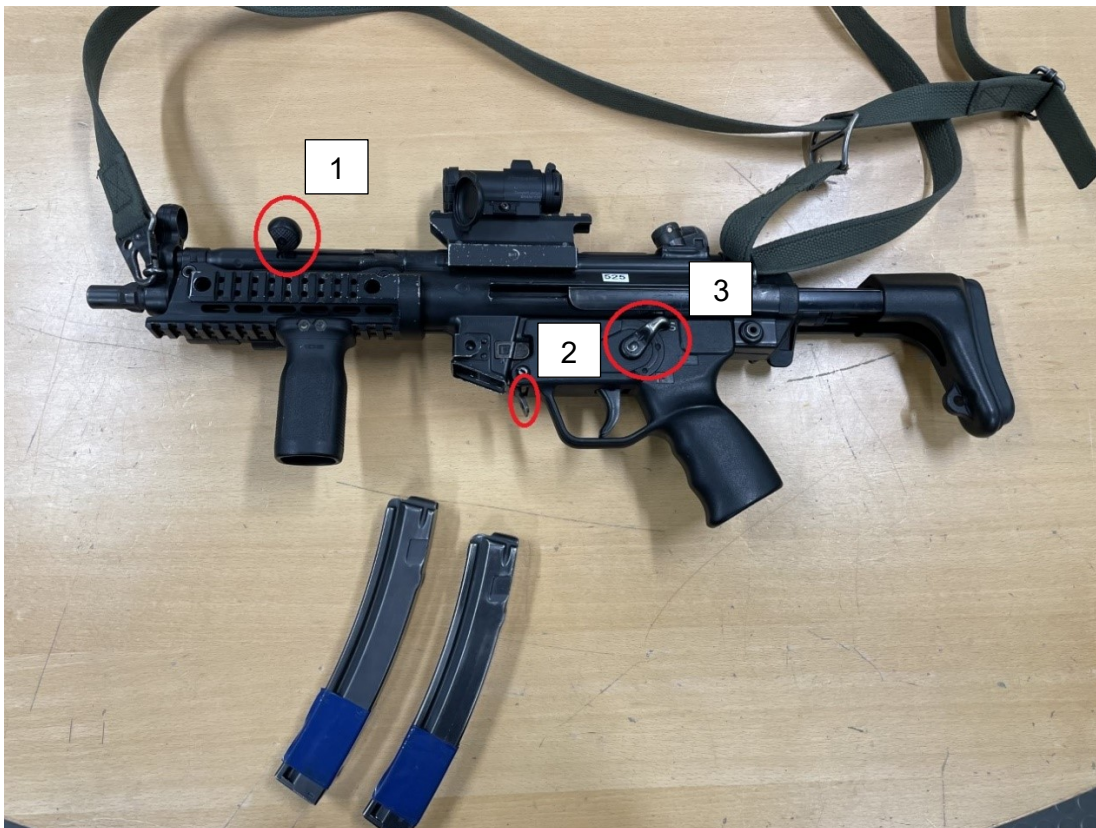
Kuva 6: MP5 vasemman puolen hallintalaitteet. Kuvaaja: Kristian Himberg 16.2.2022.
