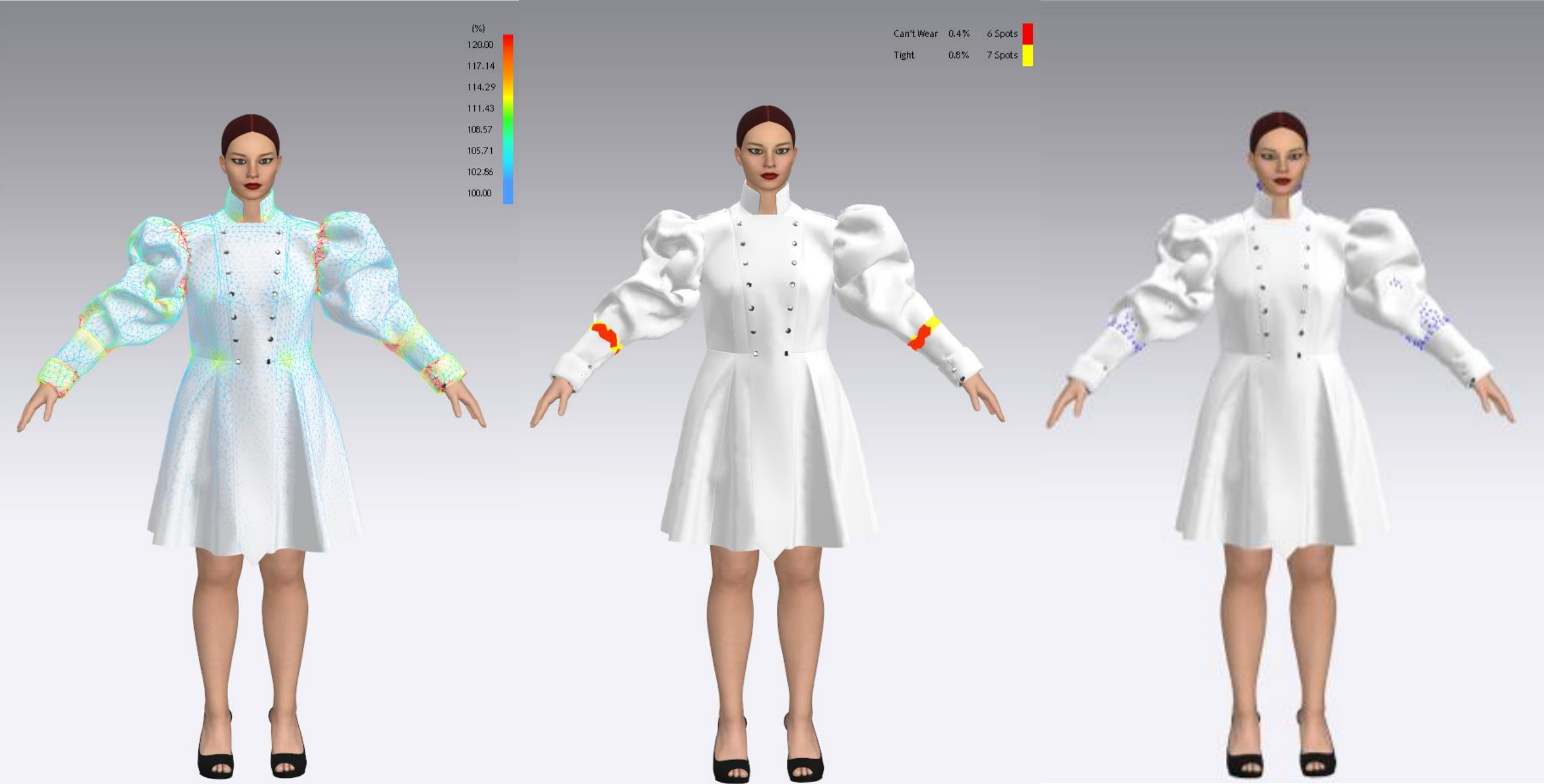
Kuva 32. Strain map kertoo punaisella kohdat missä on suuri vääristymä, distortion , ja sinisellä ne alueet missä vääristymää ei ole. Muut värit kertovat liukumista kahden ääripään välillä. (Clo 3D 2022)
