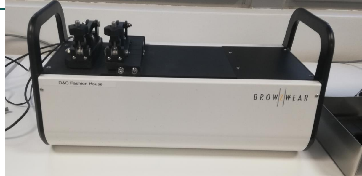
Kuva 56. Fabric Analyzer (Fab) auttaa tekstiilimateriaalin fyysisten ominaisuuksien määrittelyssä (Pitkänen 2022)
