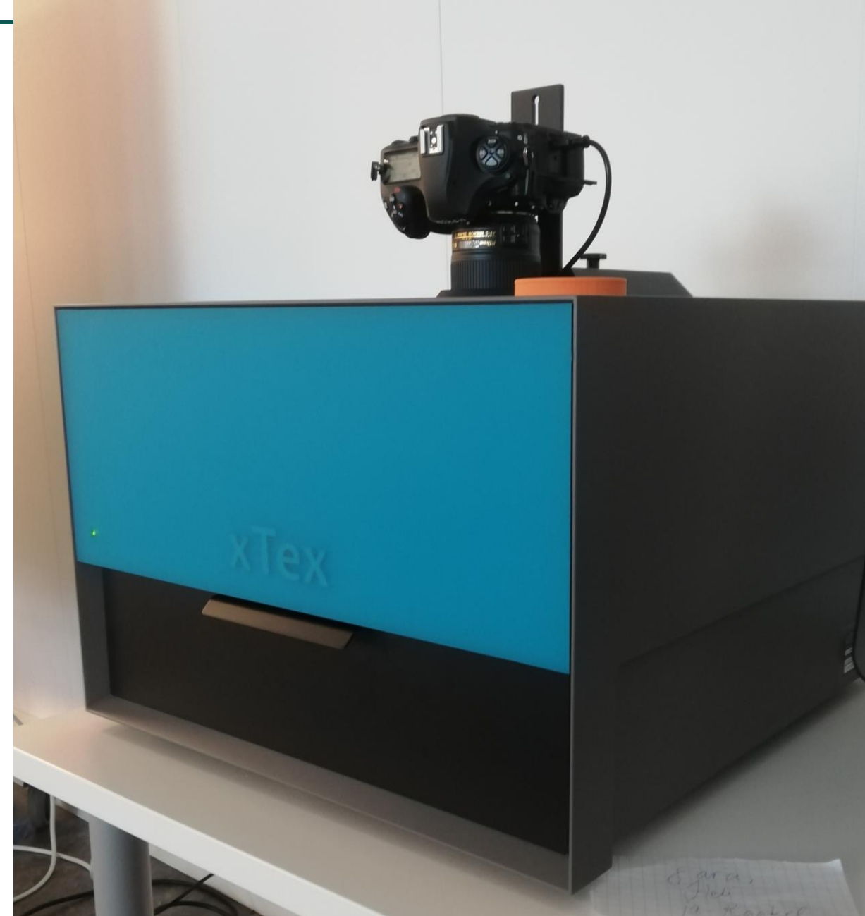
Kuva 48. Materiaaliskanneri on kuin pieni studio, jossa Nikonin järjestelmäkamera ottaa tekstiilimateriaalista kuvia, kuvien pohjalta voidaan määrittää tekstiilimateriaalin tekstuurikartat (Pitkänen 2022)
