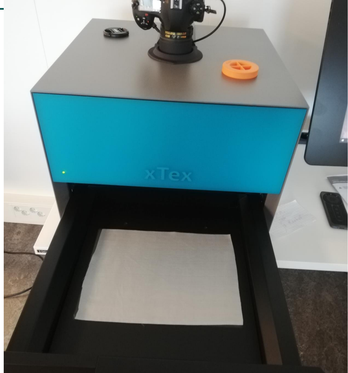
Kuva 49. Materiaaliskannerin edessä on laatikko, jonne silitetty tekstiilimateriaali asetetaan, kuvassa näkyvä valkoinen tekstiilimateriaalinäyte havainnollistaa asiaa (Pitkänen 2022)
