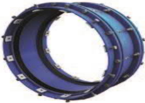
Kuva 36. DuraGrip-jatkoliitin, jossa kiristuspultit laippakehällä ja lukkohampaiden kiristys pultit liittimen ympärillä. (Saint-Gobain 2019)
