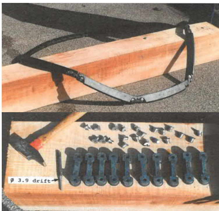
Kuva 31. Segmenttilukkorengas kootaan metalliosista joustavilla kumielementeillä ja nastoilla. (Saint-Gobain 2020)
