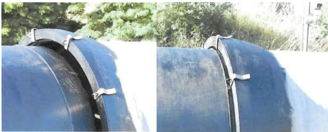
Kuva 34. Universal Ve-putken muhvi- ja pistopäät, pistopäässä hitsauspalko ja muhvilla hakasilla segmenttilukkorengas. (Saint-Gobain 2020)
