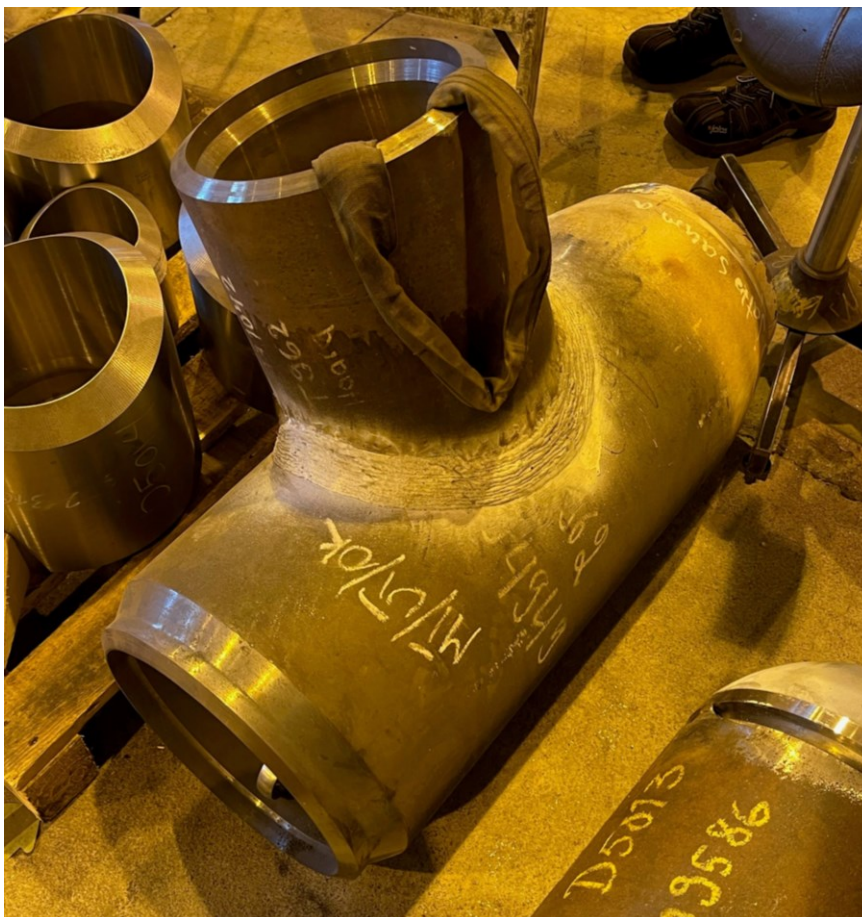
Kuva 3. Haaroitus suorassa putkessa kohtisuoraan runkoon nähden.
