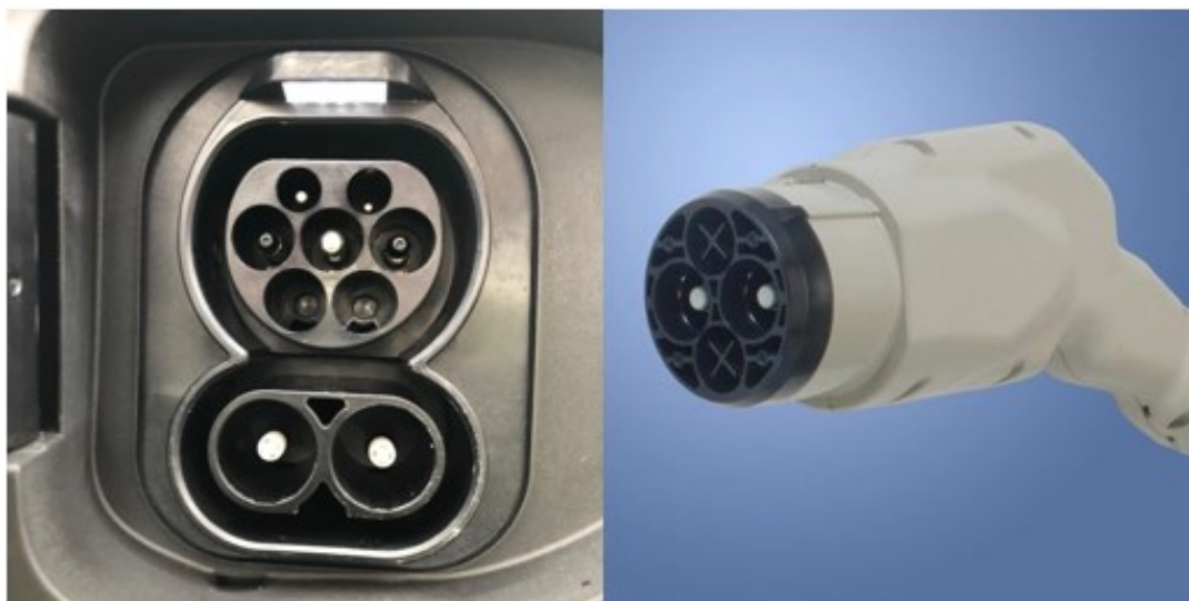
Kuva 4. Kuvassa vasemmalla CCS-latauspistorasia ja oikealla CHAdeMO-pistoke (Charging Point Connector Types 2019).
