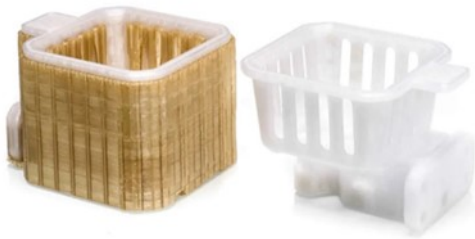
KUVA 7. Tukimateriaalia vaatinut tuloste ja sama kappale tukimateriaali poistettuna (Roberson 2021)
