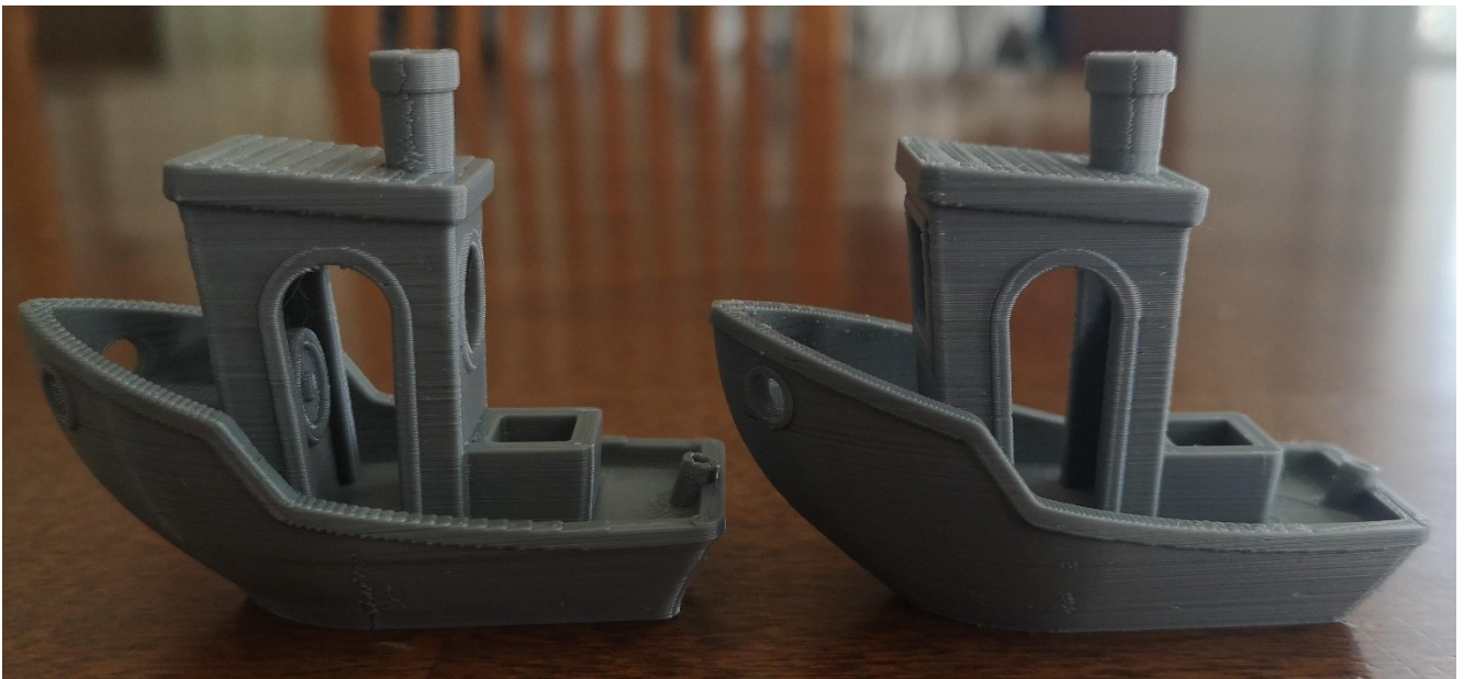
KUVA19. PLA+ filamentista valmistetut ”bentchy”
