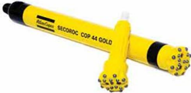
Kuva 11. Uppoporakone COP 44. (Rockdrillsales 2021.)
