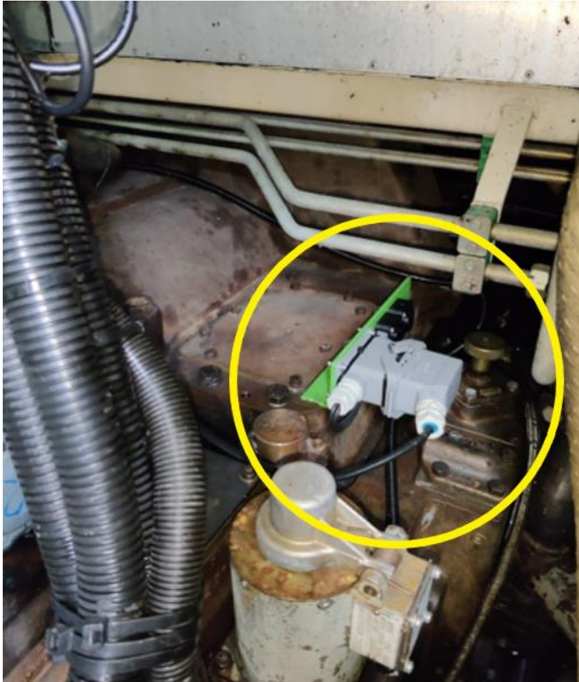
KUVA 3. Vaihteiston antureiden kiinnitys
