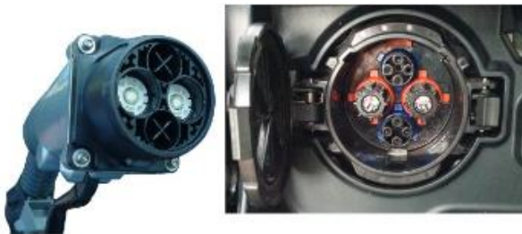
KUVA 12. Chademo-pistoketykin ja -pistoke (3, s. 36)
