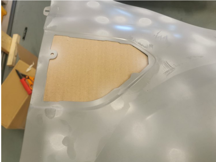
Kuva 5. Isojen reikien täyttö
