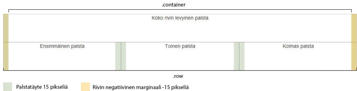
Kuva 3. Esimerkki grid-järjestelmästä, jossa on merkitty palstatäyte ja negatiivinen marginaali
