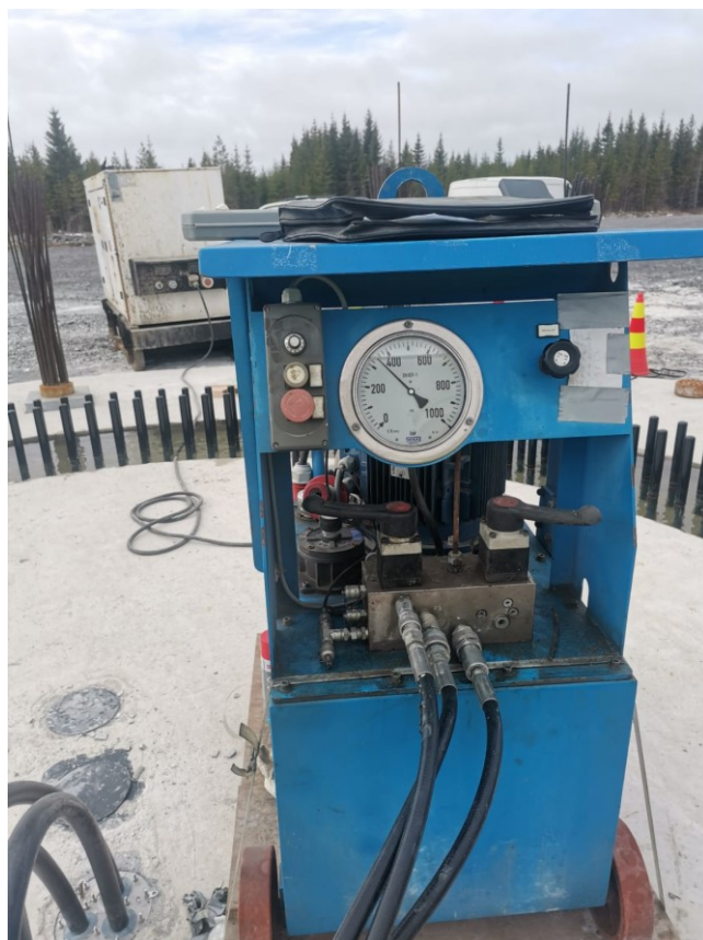
KUVA 10. Esimerkkikuva hydraulitunkin paineyksiköstä työmaalla (Mämmelä 2021)
