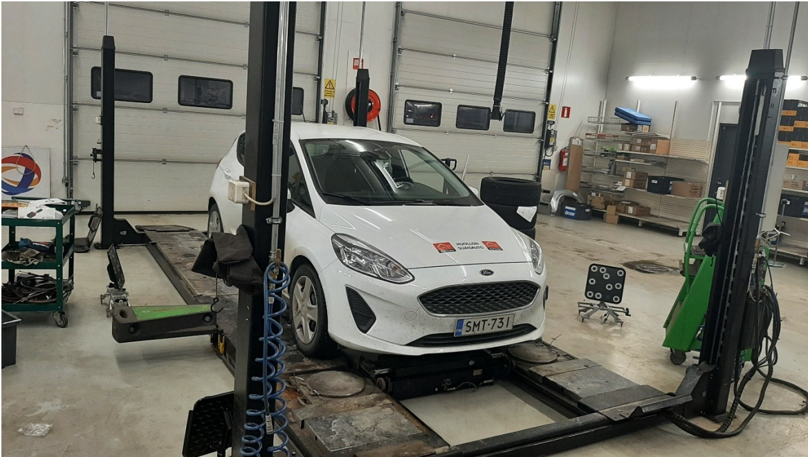
Kuva 12. Korjaamon nelipilarinostin ja suuntauslaitteisto.
