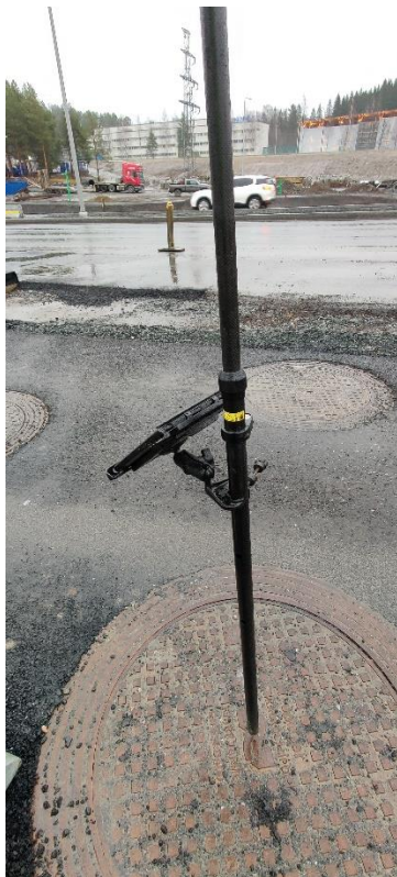
Kuva 4.2 Tarkemittaukset GNSS-sauvalla (Nykänen 2021)
