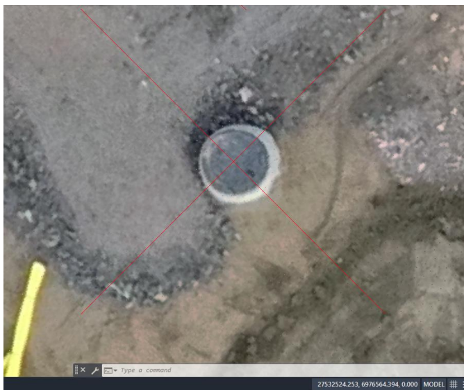
Kuva 4.4 Kaivon tarkkuus Civil 3D:ssä (Nykänen 2022)
