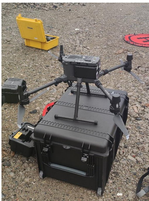
Kuva 4.1 Savonian DJI Matrice 300 RTK -drone (Nykänen 2021)
