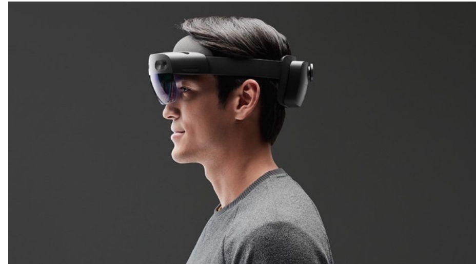
KUVA 44. Microsoft HoloLens 2. Projektiojärjestelmä luo moniulotteisia värillisiä kuvia 2k:n tarkkuudella (Ingram Micro 2020)
