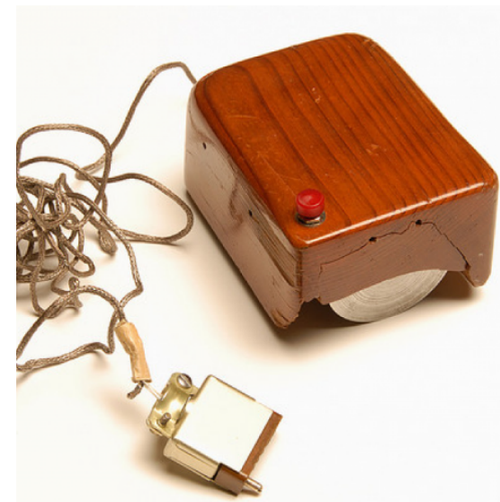
KUVA 26. Douglas Engelbartin tietokoneen hiiri (Timegraphics 2018)
