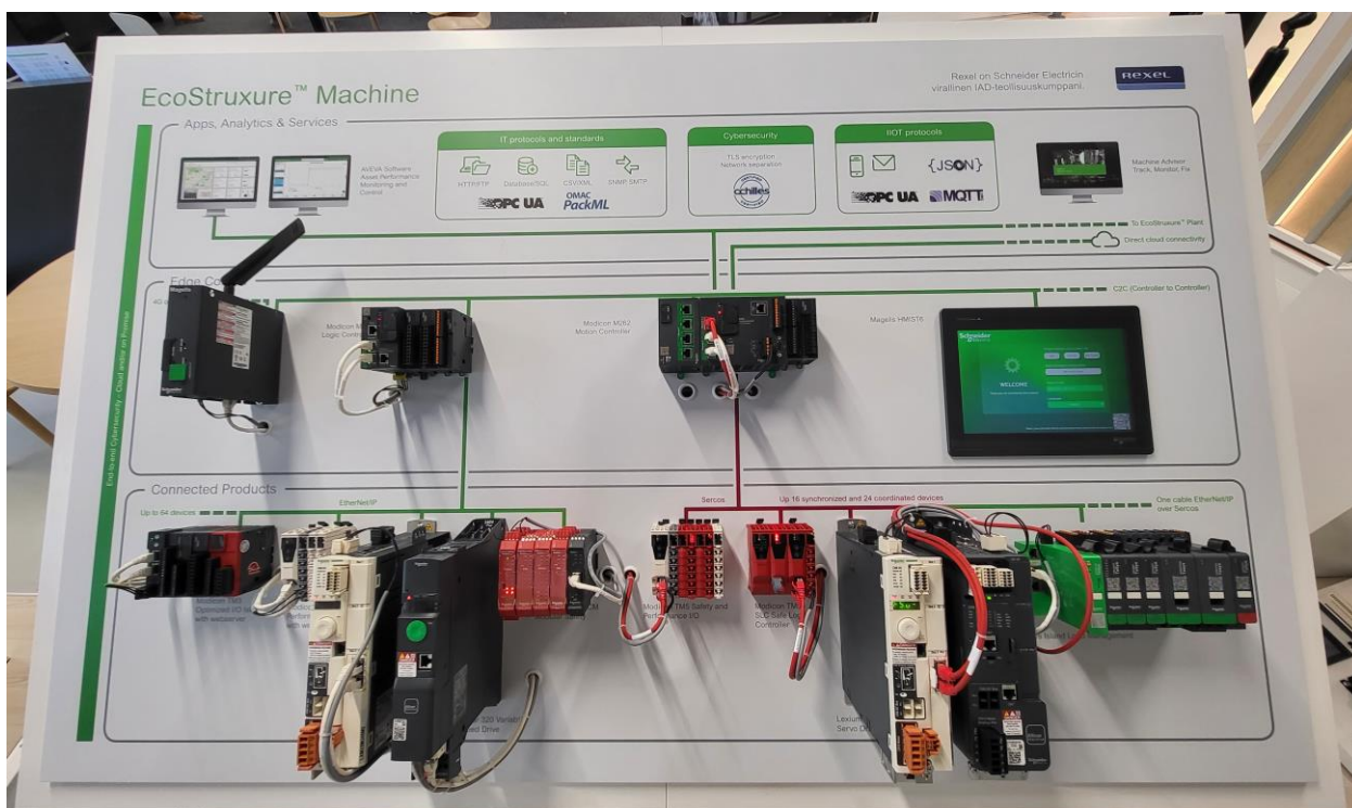
Kuva 2. Kuvassa Rexel Showroom demopöytä Vantaan Antaksentien myymälässä. Kuvassa näkyy yksinkertaistettu ratkaisu elintarviketeollisuuden laiteratkaisuista ja väylistä. [Oma kuva]
