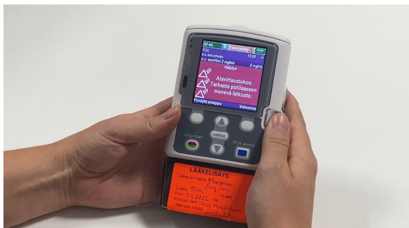
KUVA 6. CADD-Solis VIP -lääkeannostelijan korkean prioriteetin hälytysnäyttö (Kettunen 2022, CC BY-SA).
