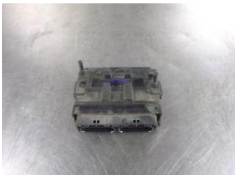
KUVA 8. Kawasaki Z1000:n ohjainlaite
