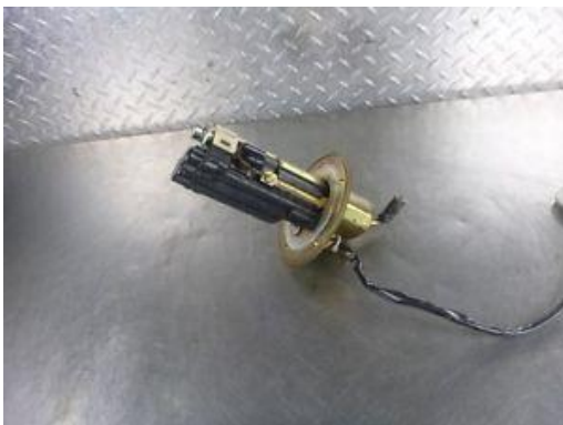
KUVA 6. Polttoainepumppu Kawasaki Z1000 (4)
