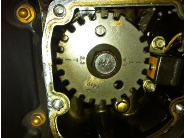
KUVA 17. Kampiakselin asentopyörä (alkuperäinen)
