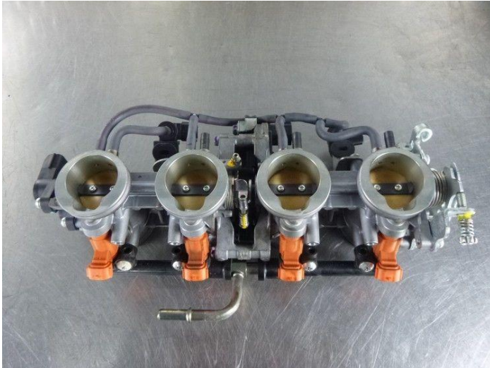
KUVA 5. Kaasuläppärungot, Kawasaki Z1000 (3)
