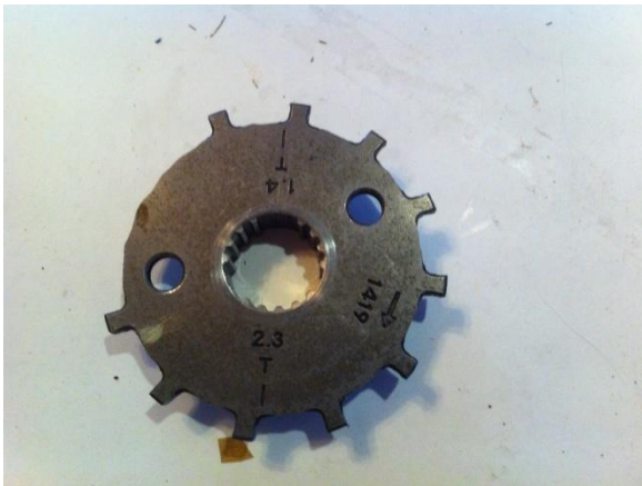
KUVA 18. Kampiakselin asentopyörä (muokattu)
