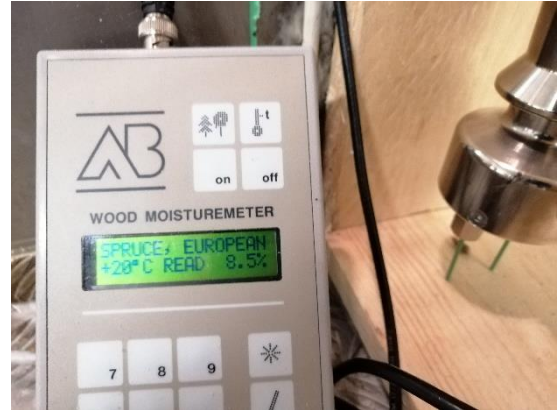
Kuva 23. Mittauslukemat osoittavat puun olevan kuivaa.
