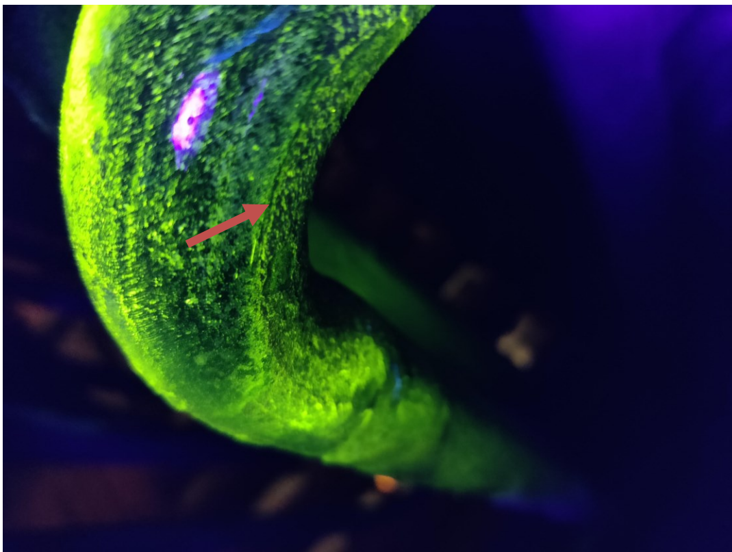
Figur 14. Skada på krök i överhettartub. (Laatutesti Oy, 2020).
