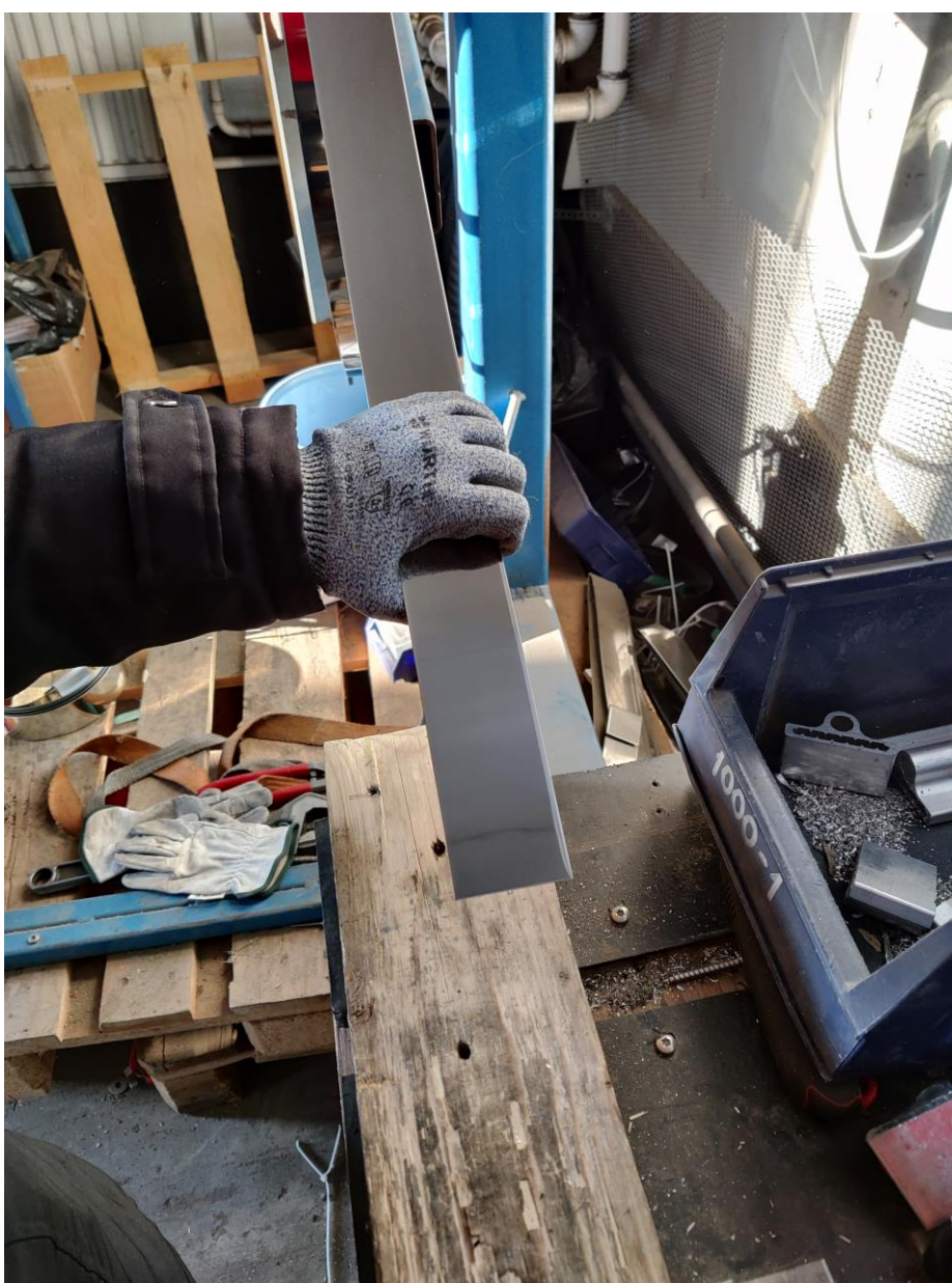
Kuva 4. Vanneaihion vetäminen kerältä lukkopalan asennuspisteelle.
