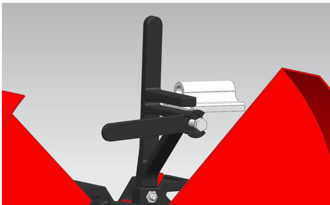
Kuva 13. Lukkopala sijoitettuna pystytukea vasten.
