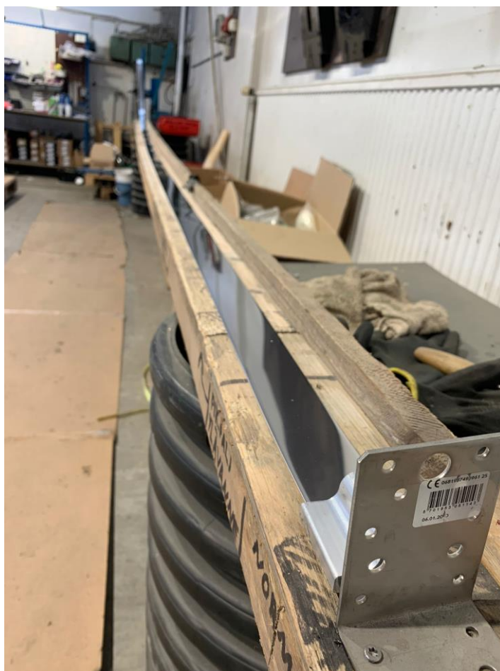
Kuva 5. Vanne vedettynä kulmarautaa vasten.
