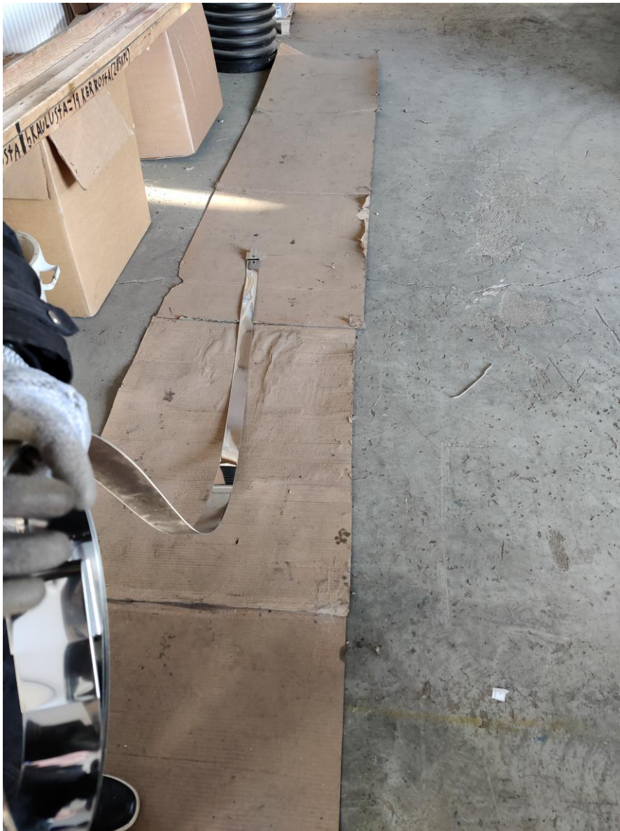
Kuva 8. Vanteen pää raahautumassa pahvia pitkin kerälle keräämisen aikana.
