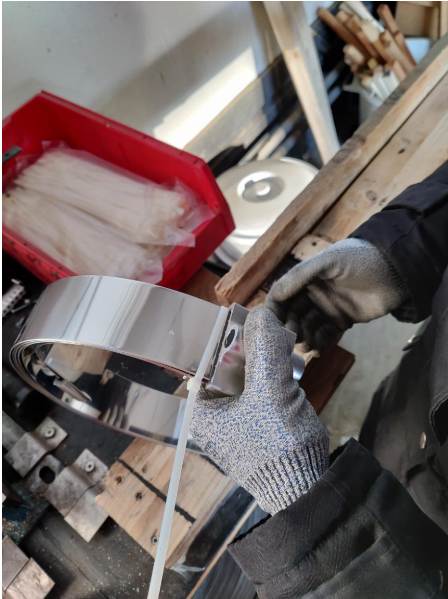
Kuva 9. Valmis vanne kerä kiristetään yhteen nippusiteellä.
