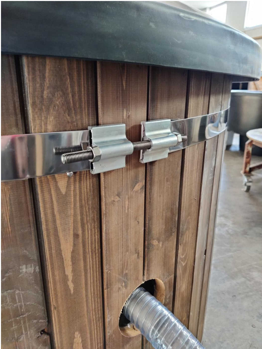
Kuva 1. Valmis vanne asennettuna kylpytynnyriin.
