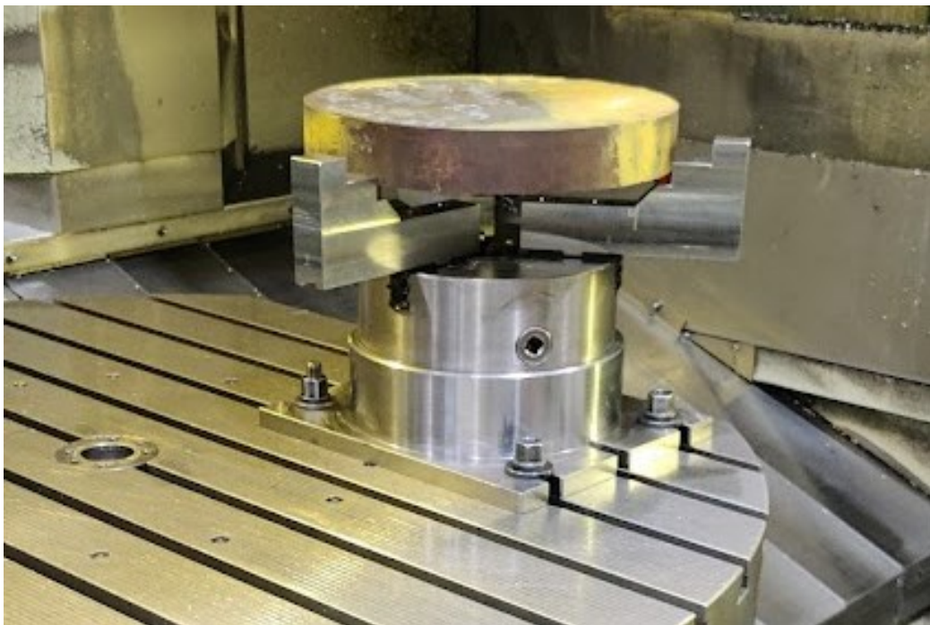
Kuva 35. Kannen kiinnitys työstökeskukseen. (Micael Koski 2022.)
