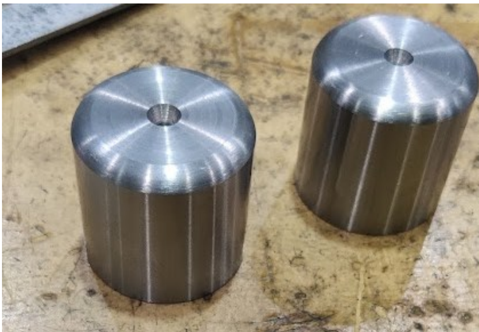
Kuva 33. Sorvatut ja hiotut kohdistustapit. (Micael Koski 2022.)
