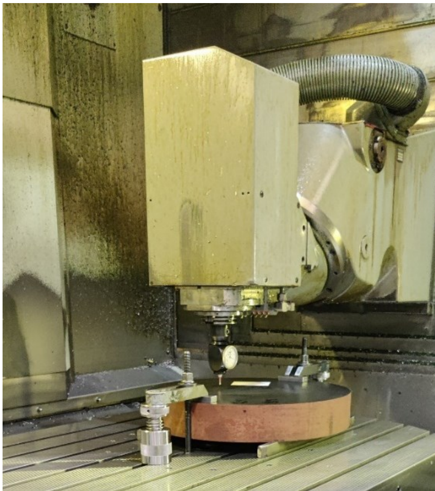
Kuva 24. Alaosan aihion kellotus paikoilleen. (Micael Koski 2022.)
