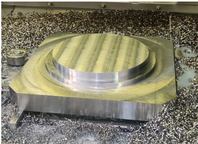
Kuva 28. Kohdistusrenkaat esikoneistettuna. (Micael Koski 2022.)
