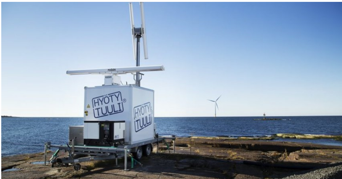
Kuva 1. Suomen Hyötytuuli Oy:n lintututka Tahkoluodon tuulipuiston läheisyydessä. (Suomen Hyötytuuli, verkkosivut, haettu 16.2.2022)
